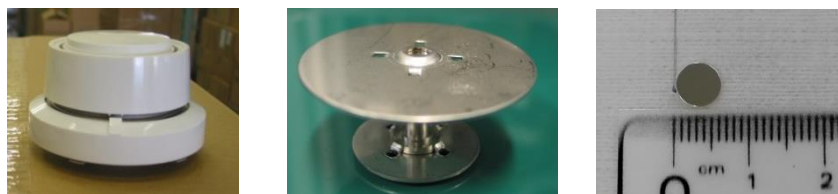
図. 感知器外観（左）及び線源ホルダー部（中）及び線源単体（右）
