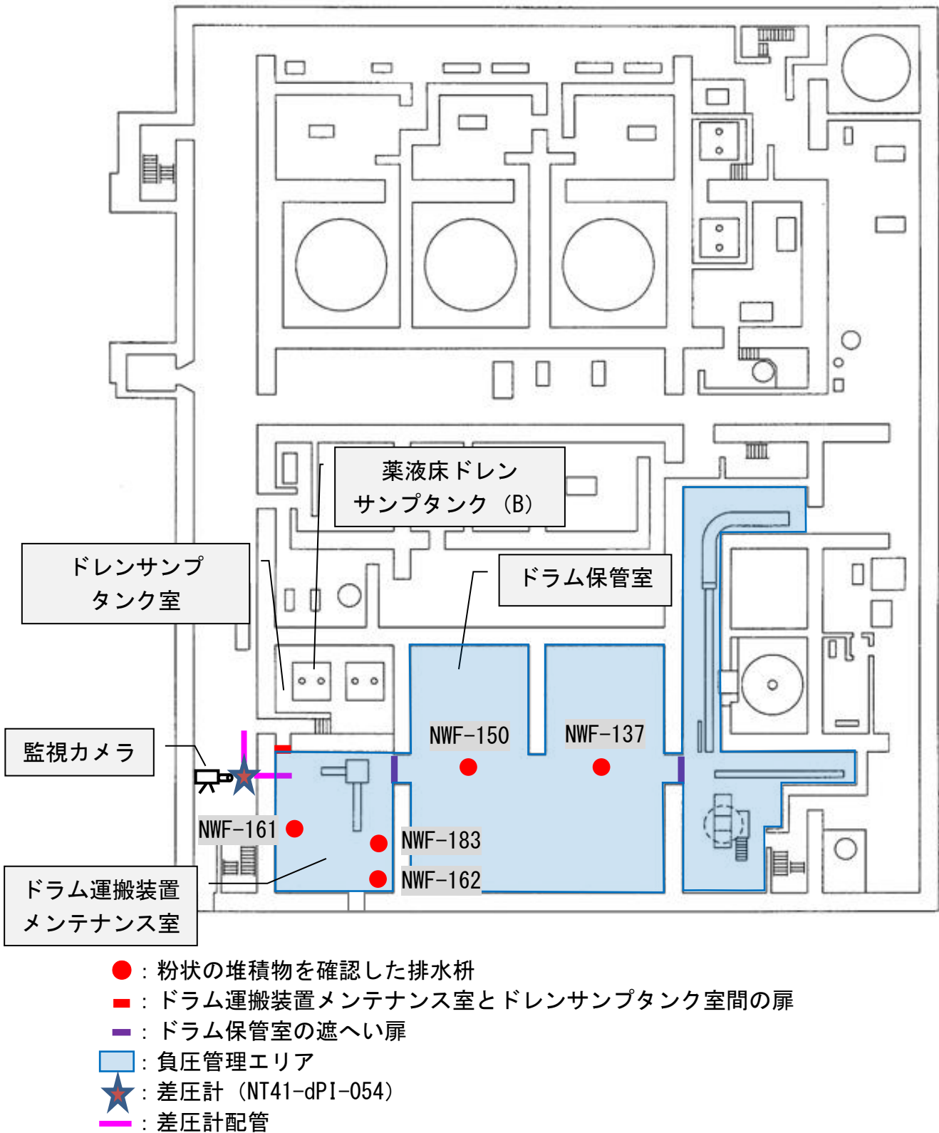
図 1 差圧監視概要図 (NRW-I 地下 2 階)
