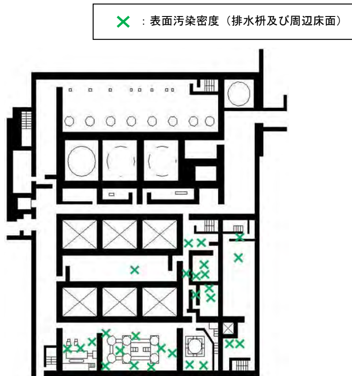
図4 測定箇所 (NRW-I 地下1階)
