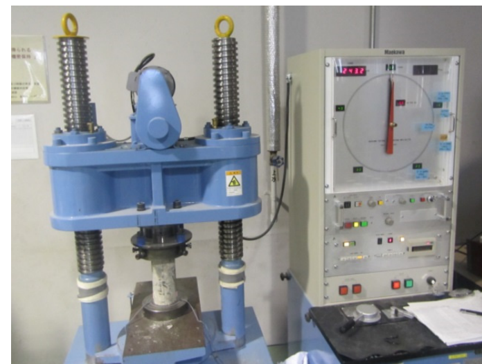
強度の点検状況
