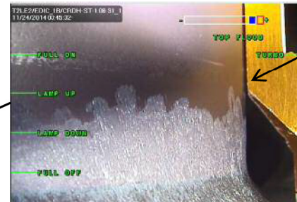
試験結果(CRDハウジングのCRDスタブチューブとの溶接部)
