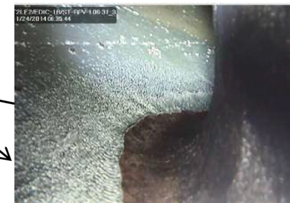
試験結果(CRDスタブチューブの原子炉圧力容器取付け溶接部)
