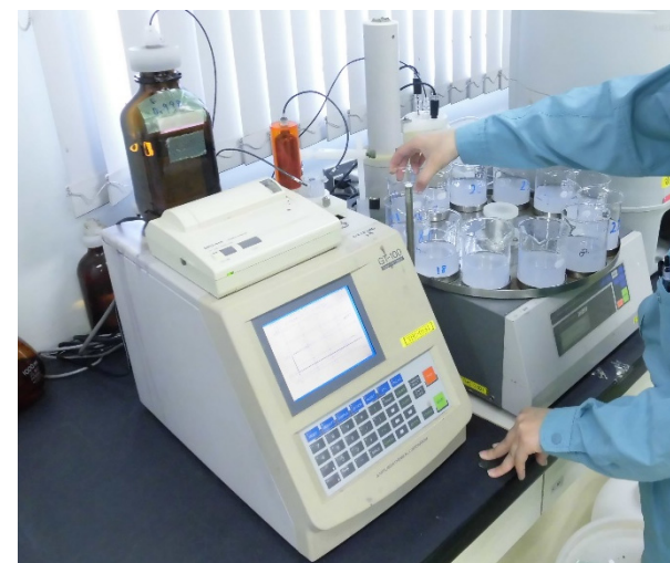
塩分浸透の点検状況
