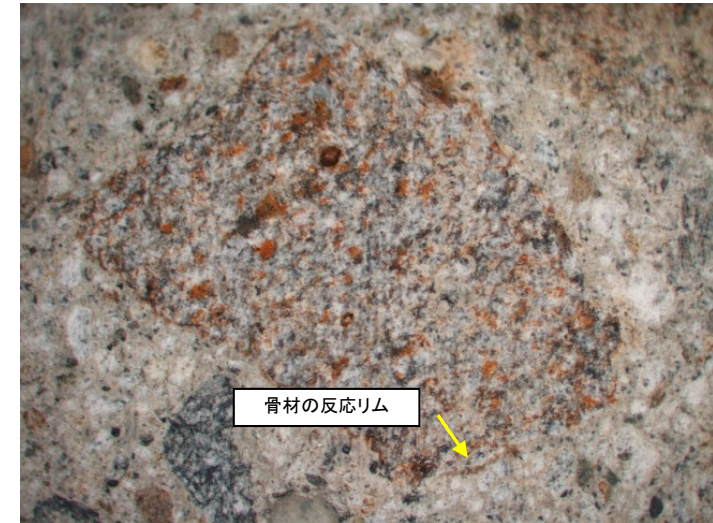
アルカリ骨材反応の点検状況 (実体顕微鏡観察状況)
