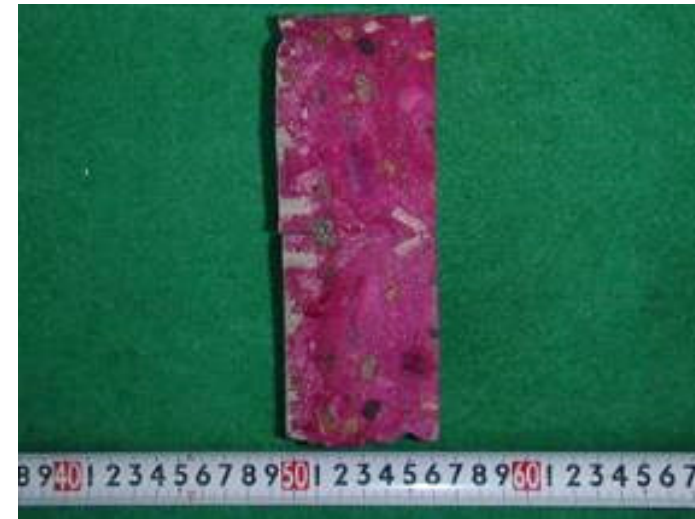
中性化の点検状況
