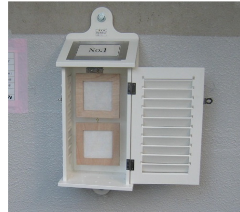
飛来塩分捕集器(ドライガーゼ法)
