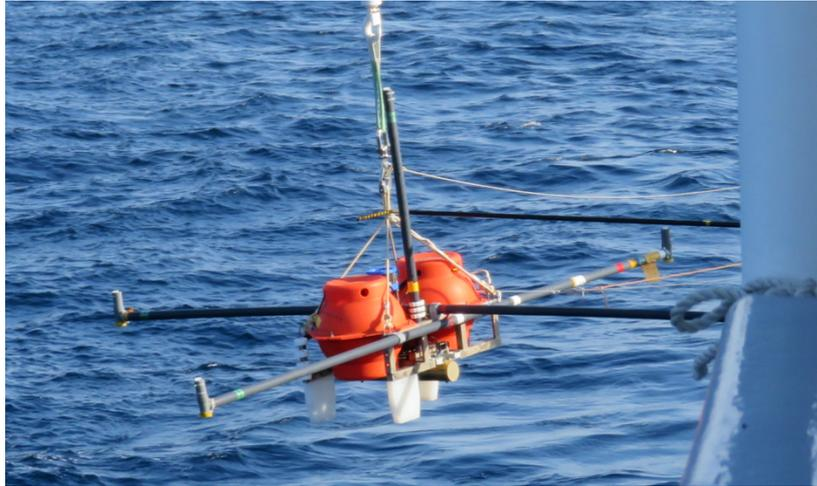
図 3.3-2 本研究で導入した OBEM の設置作業 (深江丸矢野船長撮影)
