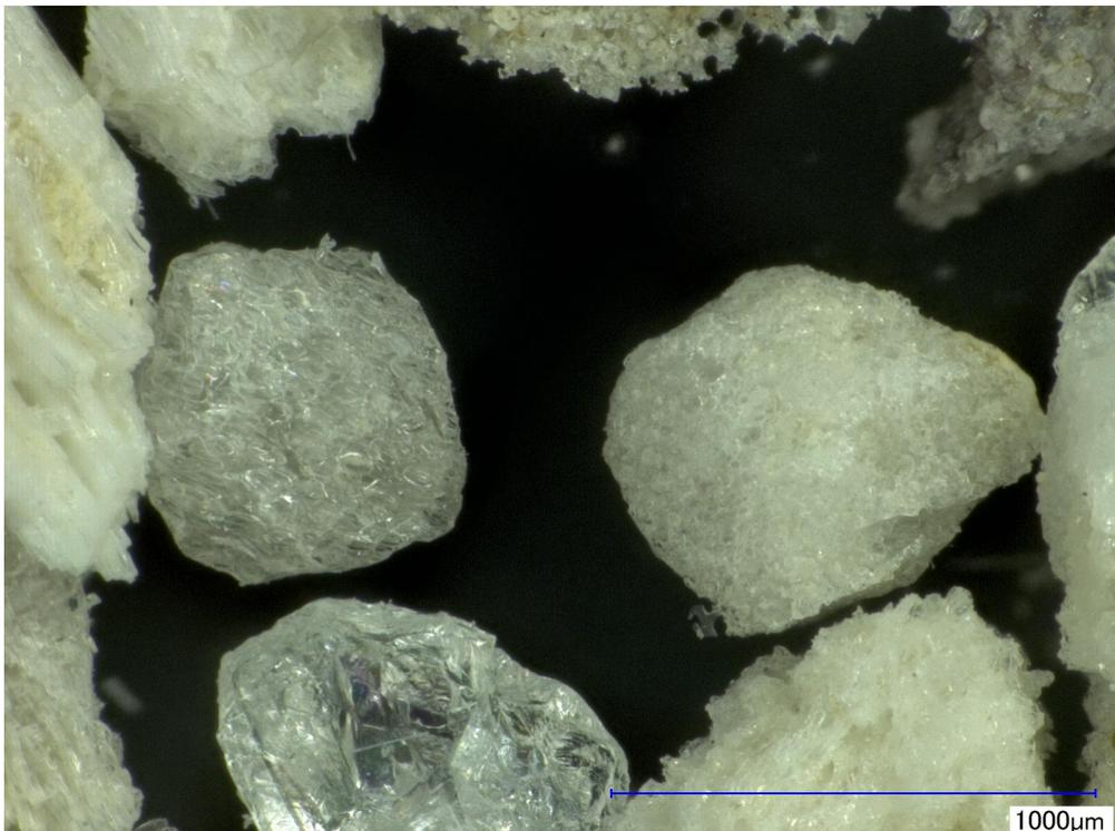
図 2.2.1-5 デジタル光学顕微鏡画像(図 2.2.1-3 の軽石の拡大). 軽石の発泡度と気泡の伸ばされ方は様々である. 大まかな傾向としては, 発泡度の低い軽石(P1)に含まれる気泡は, 発泡度がやや高い軽石(P2)よりも伸びていない.
