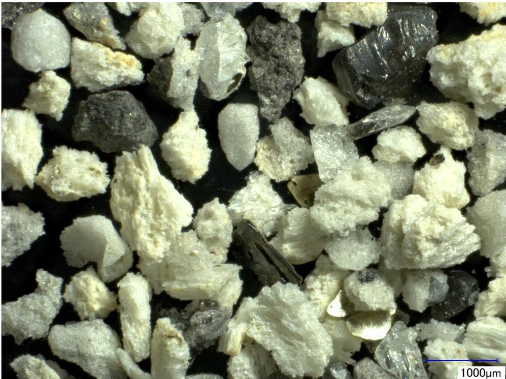
図 2.2.1-3 デジタル光学顕微鏡画像(Aso2015q-F). 軽石の発泡度は様々で, 発泡度が高いもの(P1), 発泡度が低く独立気泡のもの(P2), そして発泡度が低く破断面で囲まれたガラス(G)が存在する. 発泡度の高い軽石中の気泡は, 繊維状に伸ばされている傾向がある. 黒雲母の遊離結晶が含まれる(B). 黒雲母は, 遊離結晶のほか, 発泡度の高い軽石と, 発泡度の低い軽石中にも含まれる.
