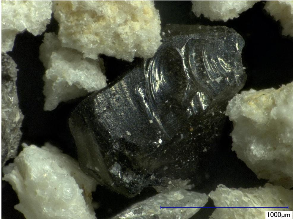
図 2.2.1-4 デジタル光学顕微鏡画像(図 2.2.1-3 の黒曜石の拡大). 黒曜石は破断面で囲まれており, 流動的に引きちぎられた外形を呈するものは, 観察した限りでは, 見られなかった.
