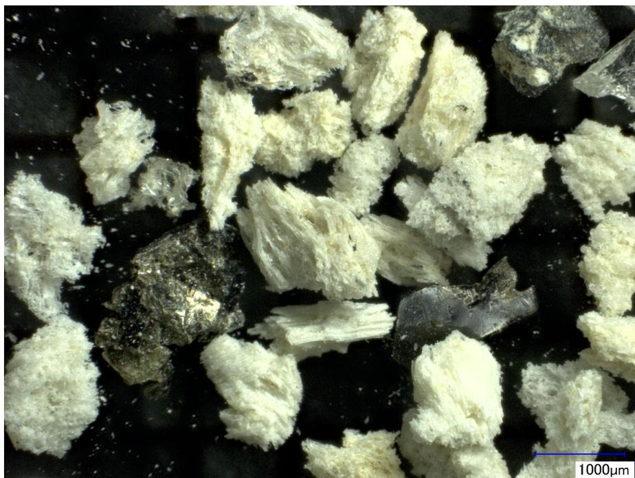
図 2.2.1-1 デジタル光学顕微鏡画像(Aso2015q-F)。水洗後 0.5~1 mm にふるいわけた。スケールバーは 1 mm。以下同様。軽石は白色で比較的発泡度が高く、気泡は繊維状に伸ばされている(P)。黒雲母の遊離結晶が含まれる(B)。破断面に囲まれた火山ガラス片も含まれる。
