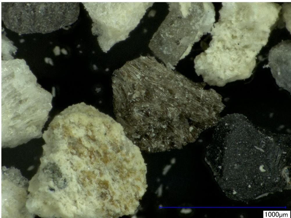
図 2.2.1-9 デジタル光学顕微鏡画像(図 2.2.1-7 の拡大). 褐色ガラスの軽石(P1)や、白色と褐色の混じった軽石(P2)が観察される.
