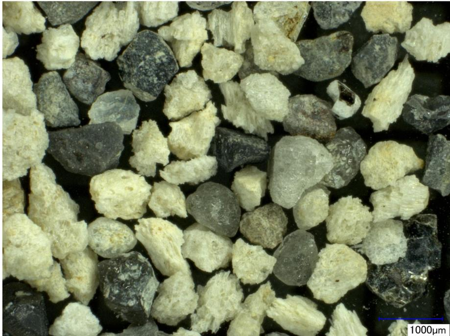
図 2.2.1-6 デジタル光学顕微鏡画像(Aso2015q-D). 軽石は発泡度が高く、気泡は繊維状に伸ばされている。軽石の色調は Aso2015q-F や-E に比べて黄色味を帯びている Aso2015q-E に比較的多く含まれていた黒曜石の含有量は減少し、透明度の低いガラス光沢岩片(L)と、やや円磨した透明ガラス片(G)の量が増加する。黒雲母は、遊離結晶のほか(B1)、発泡度の高い軽石と(B2)、発泡度の低い軽石(B3)、透明度の低いガラス光沢片(B4)のいずれにも含まれている。
