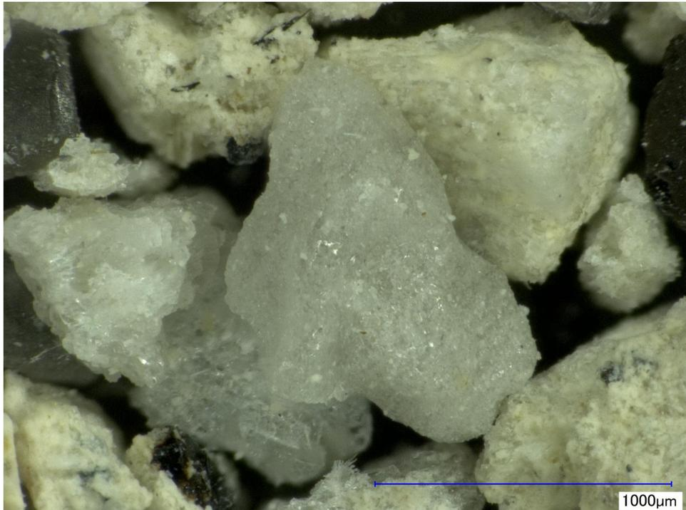
図 2.2.1-8 デジタル光学顕微鏡画像(図 2.2.1-7 の拡大). 発泡度の高い軽石中にも、黒雲母が含まれている(B).
