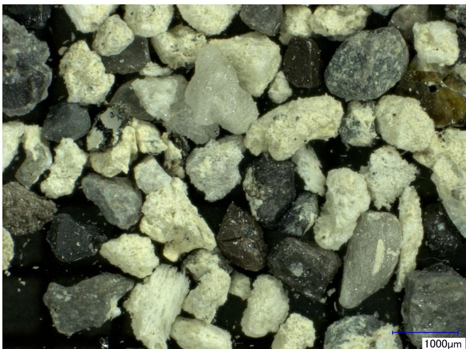
図 2.2.1-7 デジタル光学顕微鏡画像(Aso2015q-C). 軽石の発泡度と気泡の伸ばされ方は様々である。軽石の色調は Aso2015q-D に比べて黄色味を帯びている。黒雲母の遊離結晶が含まれるが Aso2015q-D に比べると少ない。
