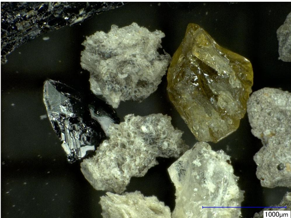
図 2.2.1-11 デジタル光学顕微鏡画像(Aso2015q-A の拡大). 軽石は白色と褐色が不均質に混合した、いわゆる縞状軽石である.
