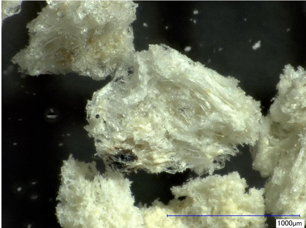
図 2.2.1-2 デジタル光学顕微鏡画像(図 2.2.1-1)の拡大. 軽石の中にも黒雲母斑晶が含まれている(B).
