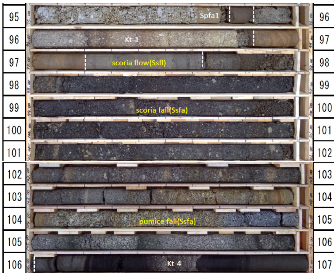
図 1.1.17. ボーリングコア写真(PE2).
