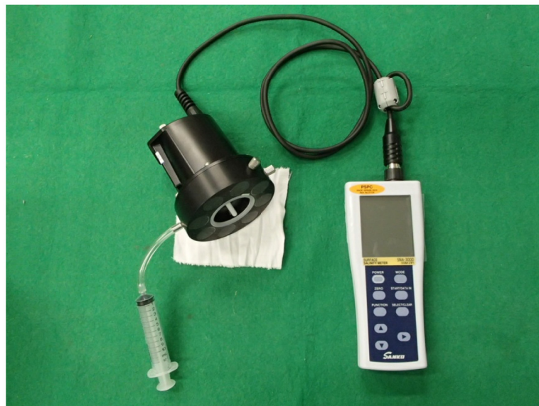
図 4. 1. 4-3 表面塩分量測定器 (ポータブル表面塩分計)
