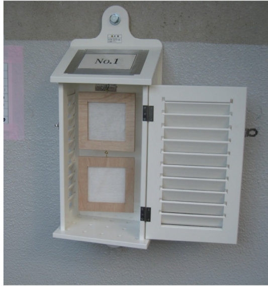
図 4. 1. 4-2 飛来塩分捕集器 (ドライガーゼ法)
