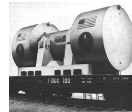
破損燃料輸送に使用された国外キャスク （TMI-2の例）
