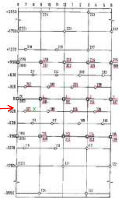
図 4.3.3-8 損傷パラメータの分布と試験体における破損位置の比較 (12,140 秒、-191.1 mm 付近)
