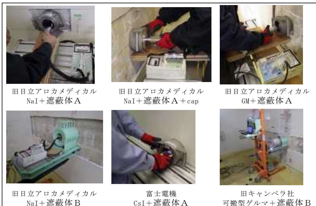
図 4.2 測定器とコリメータの使用状況
