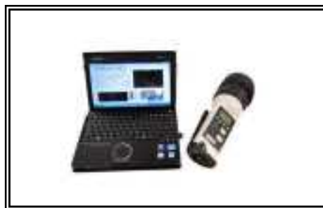
図 2-15 ラジプローブシステム (走行しながら空間線量率の測定・記録・通信が可能)
