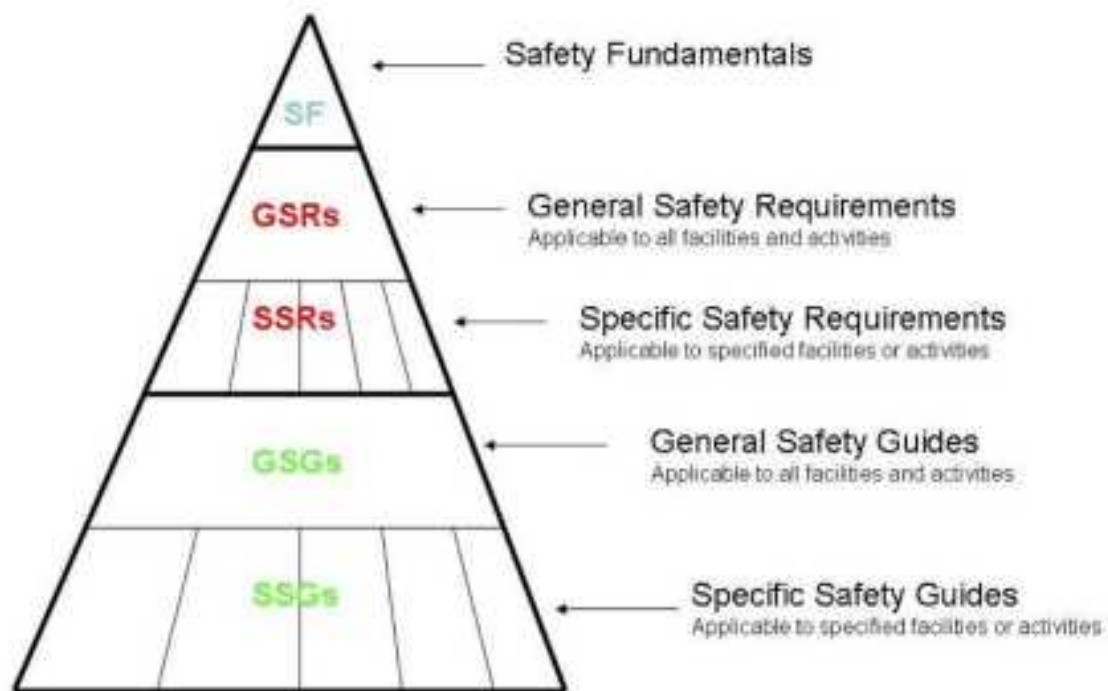
図 1.2-18 IAEA の安全基準文書の階層構造と適用先 1)
