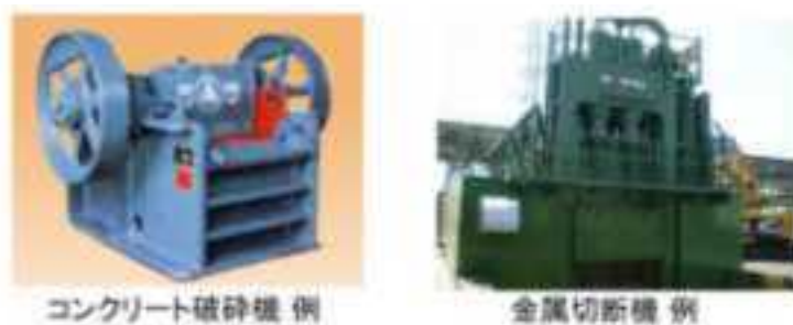
図 2.2-3 減容処理設備の例 (参考文献(2)p.8 より)
