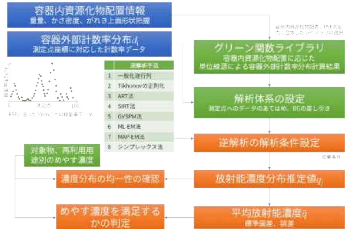
図 4.3-1 逆解析による放射能濃度分布評価コードシステムの概要
