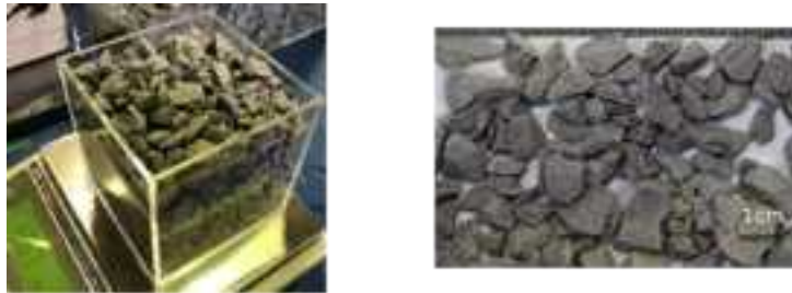
図 1.3-44 碎石 6 号をアクリルボックスに詰めた状態及び粒子の拡大図
