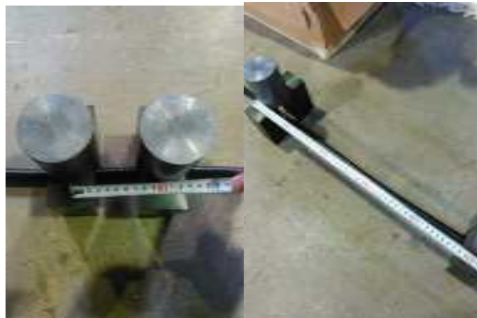
図 4.4-7 同線源強度による複合ピークの確認試験
