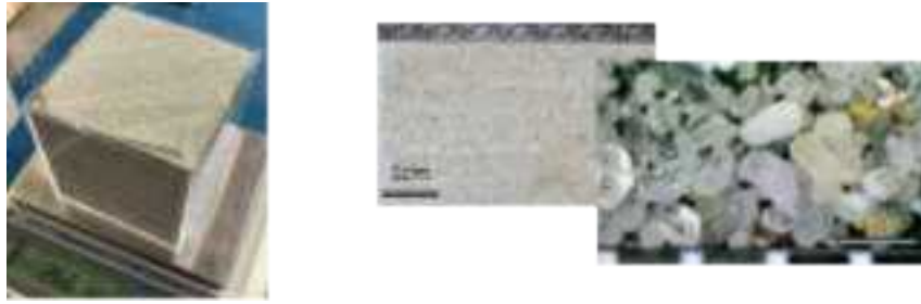
図 4.7-2 珪砂 6 号をアクリルボックスに詰めた状態及び粒子の拡大図
