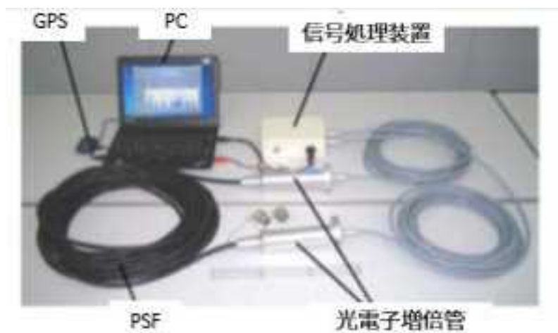
図 4.4-2 測定システム D-phod
