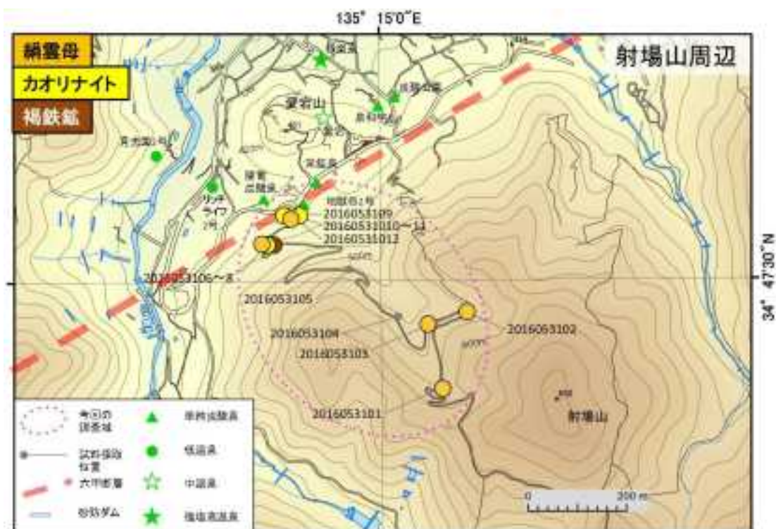
図 3.3.1.5-3 射場山への山道の変質鉱物の分布（絹雲母，カオリナイト，褐鉄鉱）。マップ範囲は図 3.3.1.1-2 の四角点線部'C'の拡大表示。X線回折実験結果により産出位置をプロットした。ただし褐鉄鉱（2016053107）は薄片観察による同定。泉源分類および位置は西村ほか（2015）による。単純炭酸泉は自然湧出であるが、低温泉、中温泉および強塩高温水は、ラッパ管や汲み上げポンプなどの揚水である。
