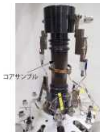
図 3.2.2.1-1 室内三軸透水試験のコアサンプル[60mm×φ30mm]と変位計の設置状況
