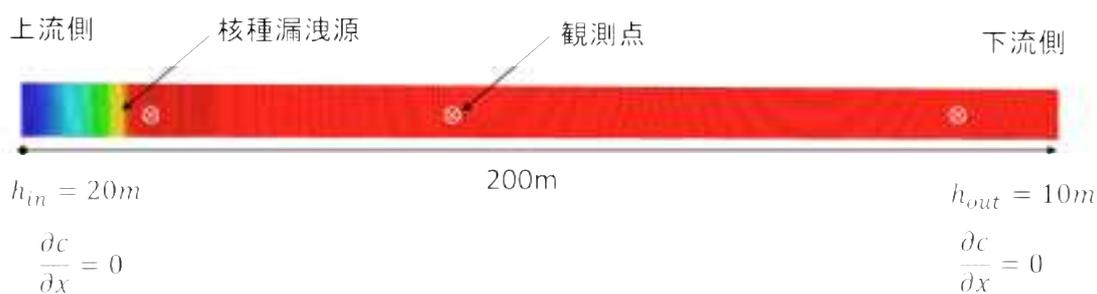
図 4-13 解析格子モデル，境界条件および観測点配置（カテゴリーA）
