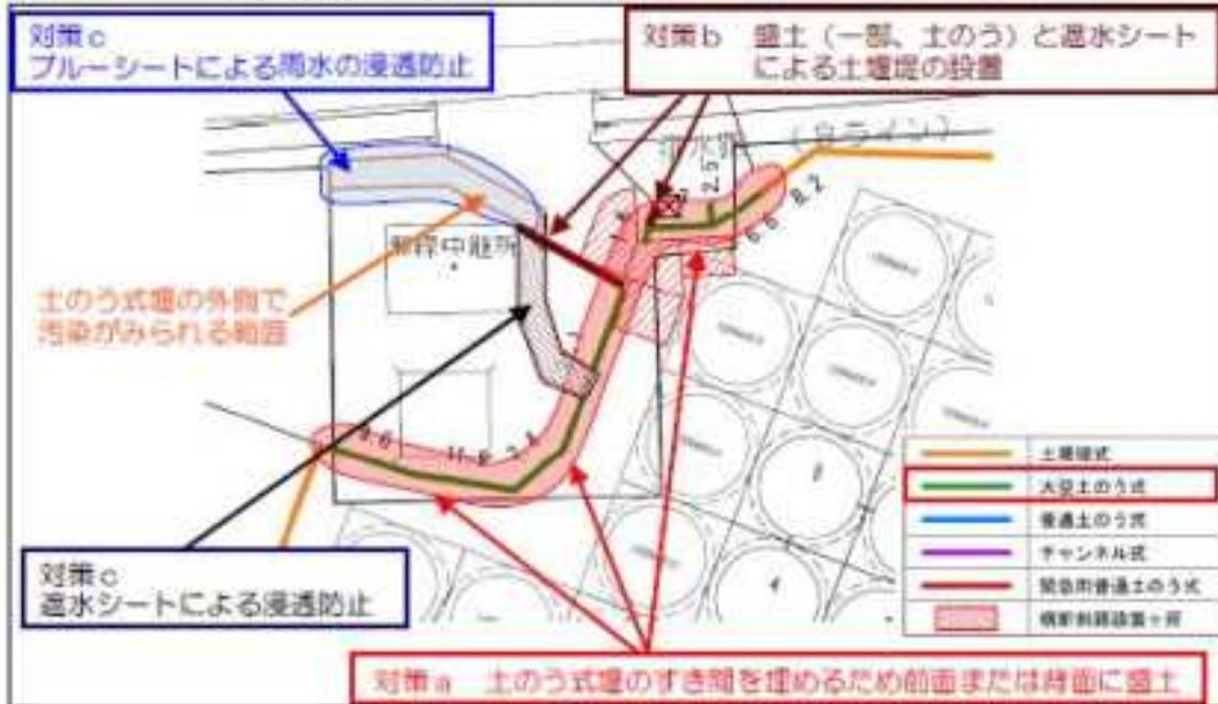
図3 土のう式堰の外側の対策
