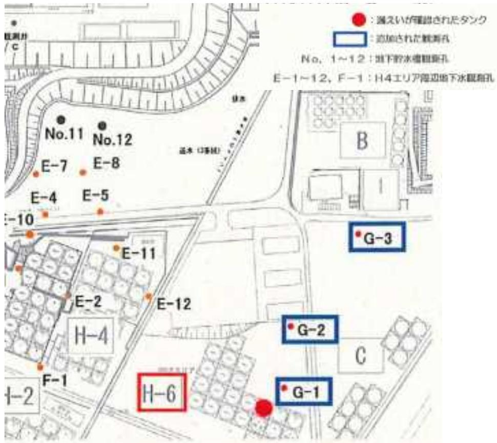
図 5-6 核種濃度観測点の配置 (H6 タンクエリア)
