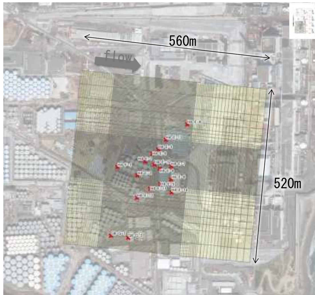
図 5-21 平面格子モデルと漏洩位置および観測井配置 (トラブル①)
