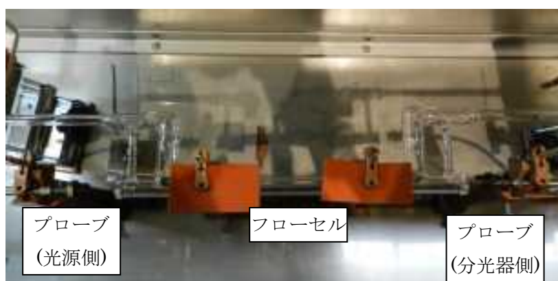
図 2-10 フローセル及びプローブの設置時の外観
