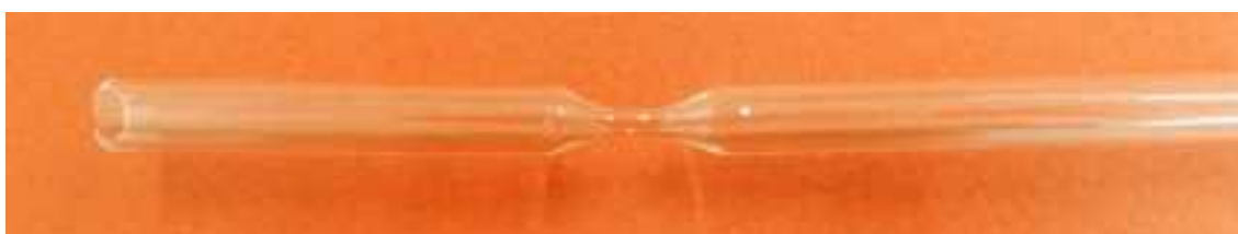
図 2-9 ガラス配管溶断予定部の構造
