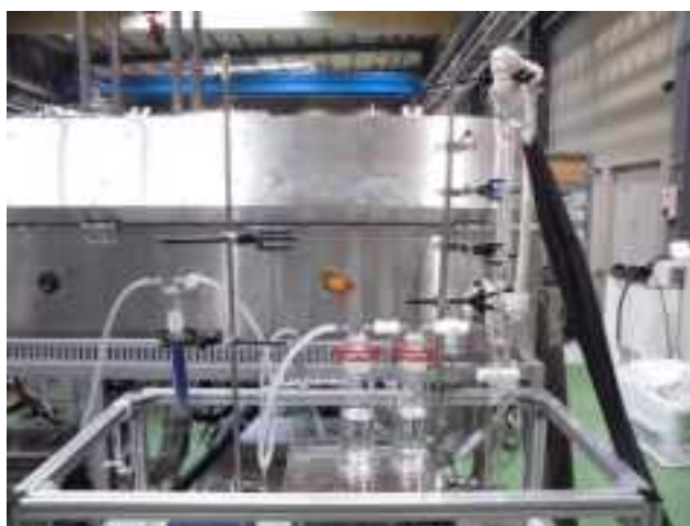
図 3.2-7 Ru 等回収部の外観
