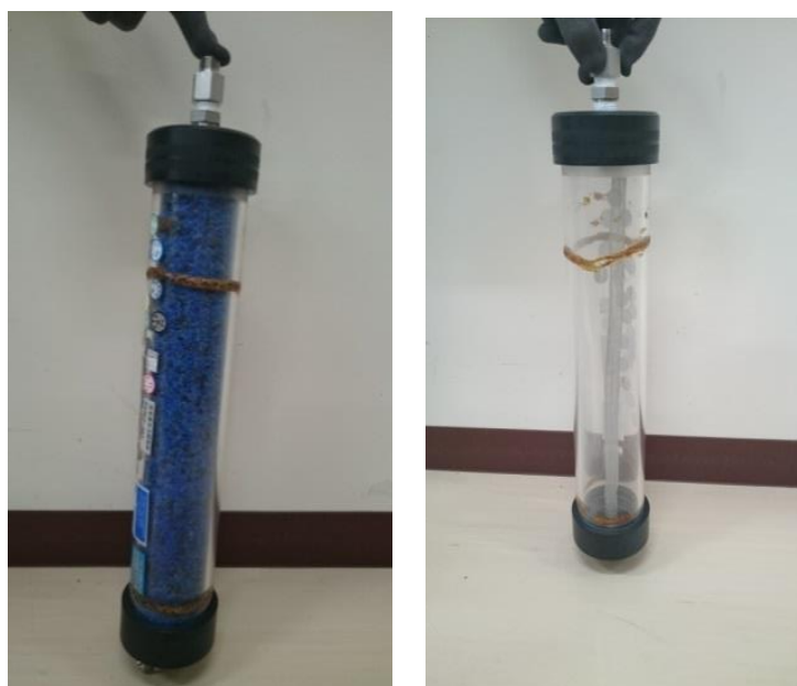
図 3.4-6 拡散ドライヤーの写真 (左：シリカゲル充填、右：シリカゲルなし)
