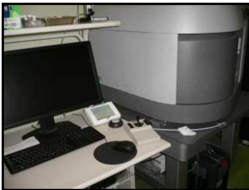
図 3-37 使用した顕微ラマン分光分析装置
