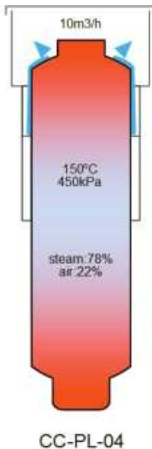
図 4.5.1-1 外面冷却実験 CC-PL-04
