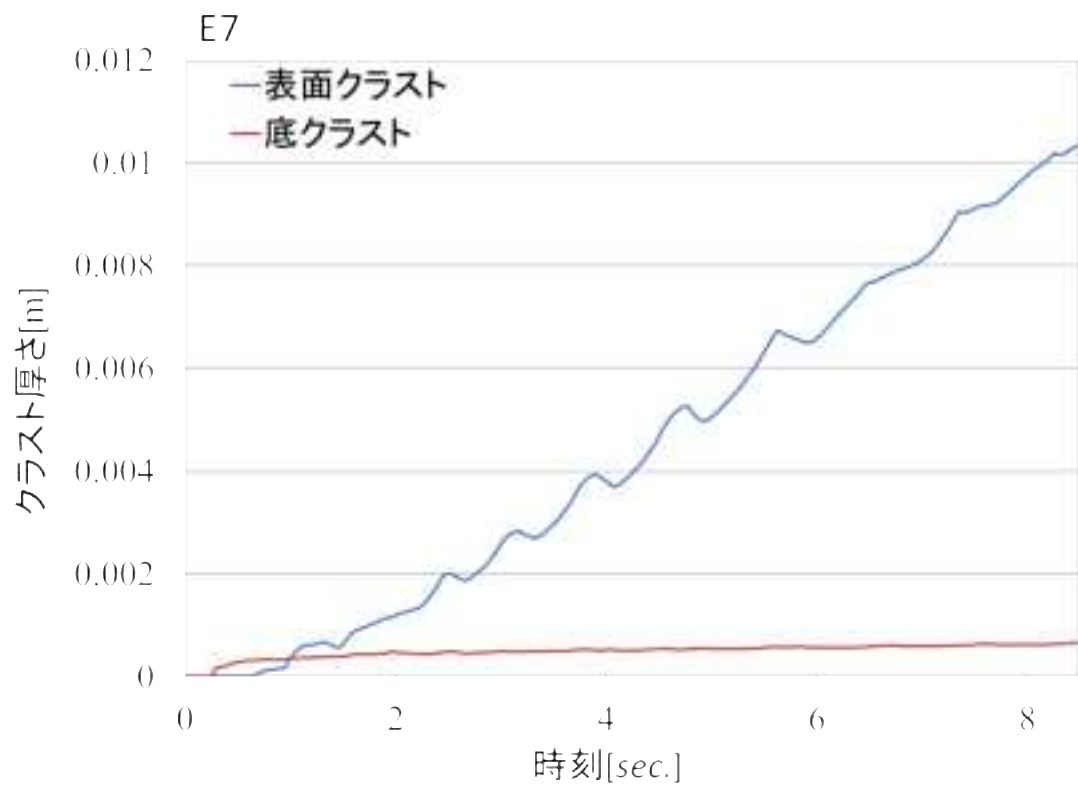
図 B.1.27 クラスト厚さの変化の計算結果 (PULiMS 実験 E7)
