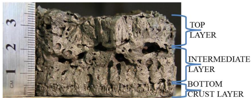
図 3.2.4 PULiMS E4 実験後の溶融物の縦断面写真
