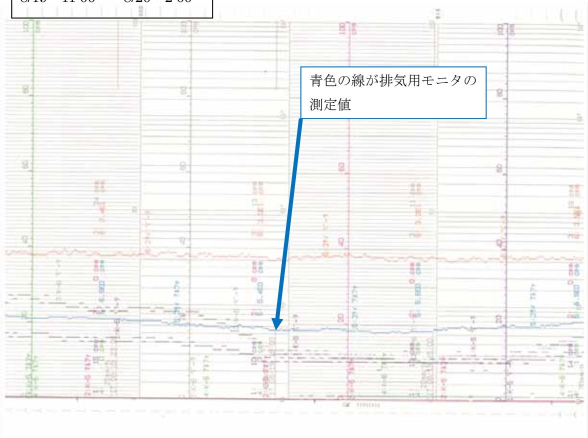
図 18 : 事象発生以降から 8 月 20 日迄の第 2 加工棟排気用モニタトレンド (8/8)
