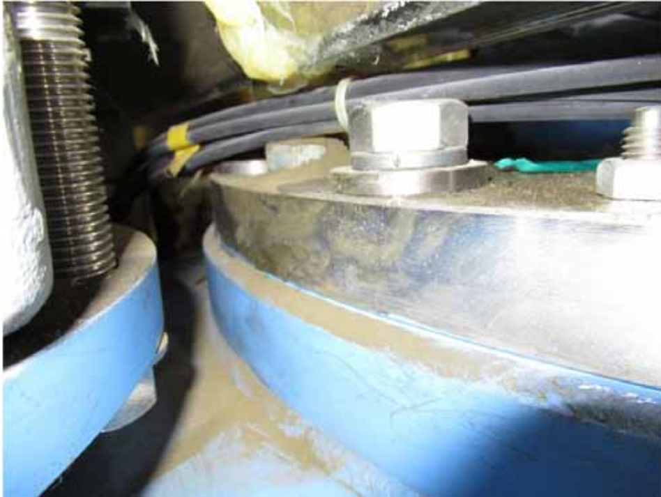
図 6 : 粉末混合機フランジ上のウランを含む粉末 (粉末混合機回転主軸フランジ操作台側) (粉末 B 発見箇所)
