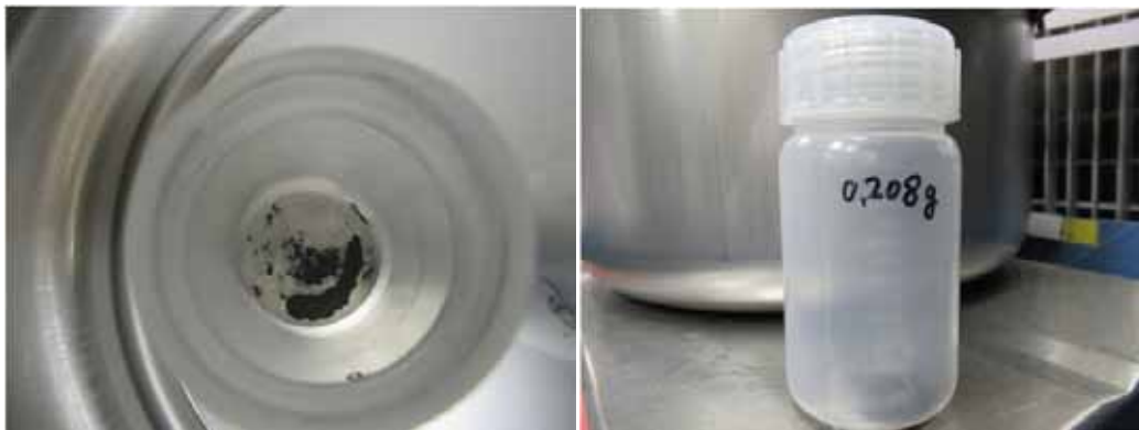
図 5 : 粉末混合機本体フランジ操作台側で発見した粉末 (粉末 A)
