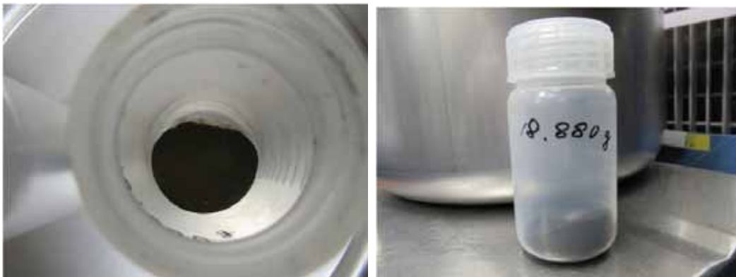
図 7 : 粉末混合機回転主軸フランジ操作台側で発見した粉末 (粉末 B)
