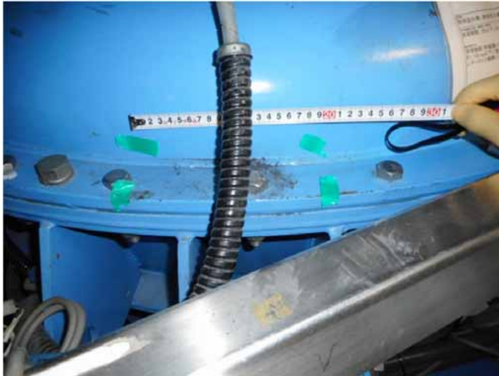
図 4 : 粉末混合機フランジ上の酸化ウラン粉末 (粉末混合機本体フランジ操作台側) (粉末 A 発見箇所)
