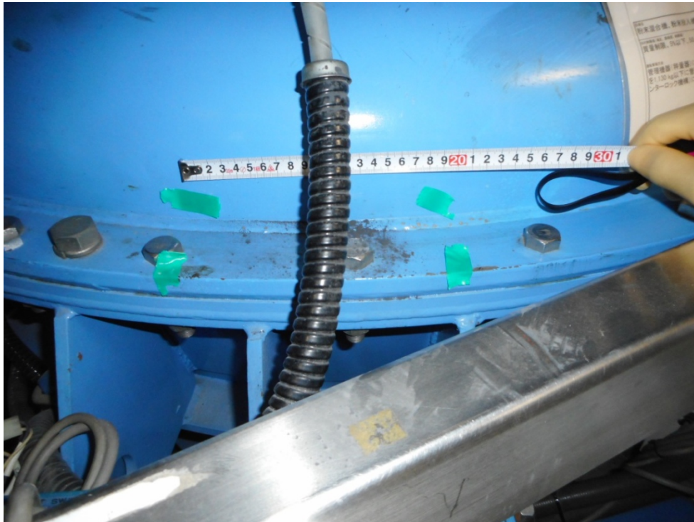
図 4：粉末混合機フランジ上のウランを含む粉末（粉末混合機本体フランジ操作台側）
