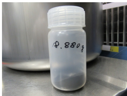
図 7：粉末混合機回転主軸フランジ操作台側で発見した粉末（粉末 B）
