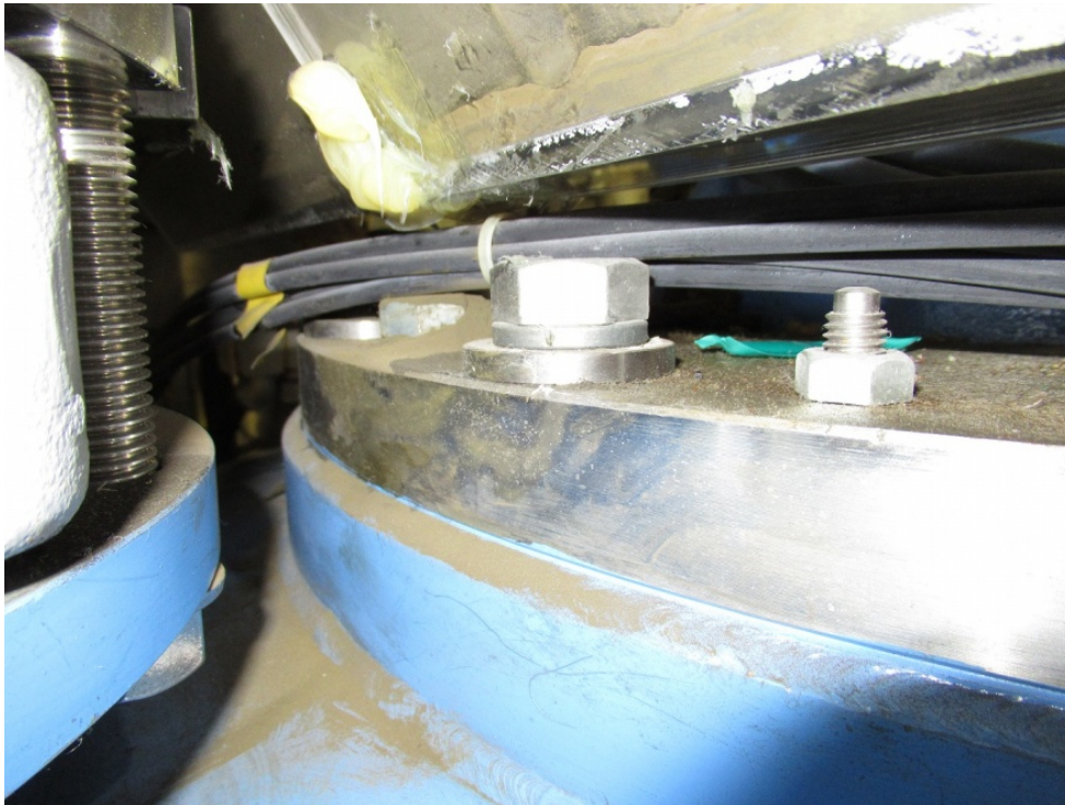
図 6：粉末混合機フランジ上のウランを含む粉末（粉末混合機回転主軸フランジ操作台側）
