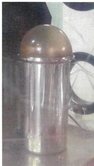
図⑭-6 蓋なし試験 破裂直前の樹脂製の袋の写真
