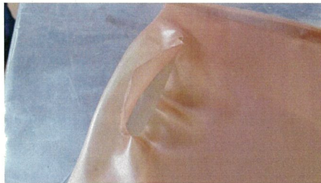
図⑭-9 蓋あり試験 破裂後の樹脂製の袋の写真
