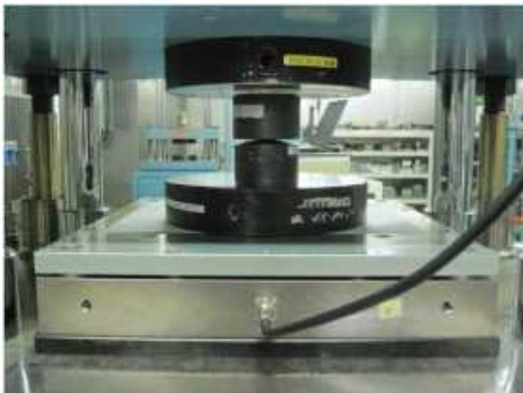
写真 5.1.2 土砂用荷重計の室内試験の様子
