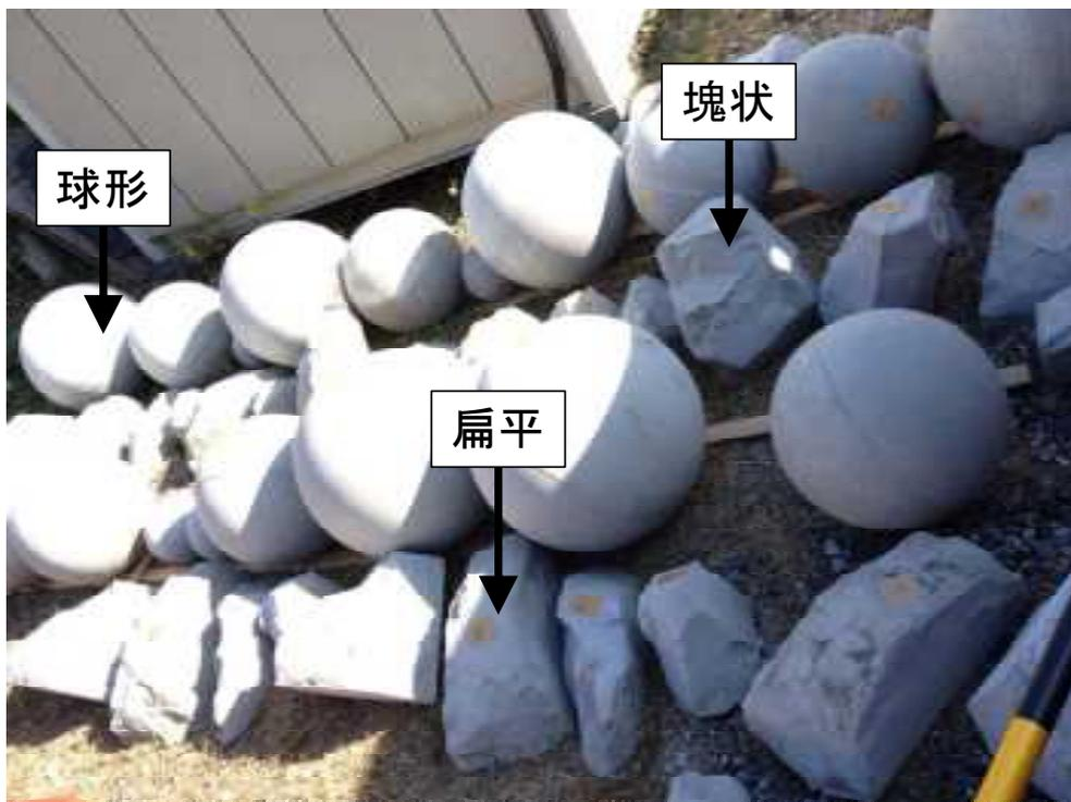
図 7.2.3 球形・塊状・扁平形状の人工岩塊
