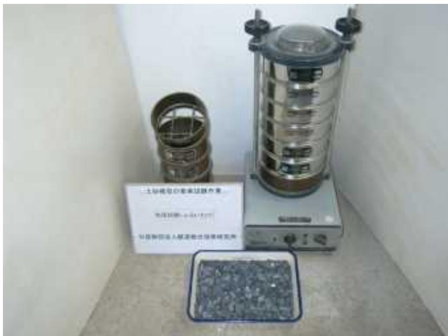
写真 7.1.4 粒度試験に使用した測定器具
