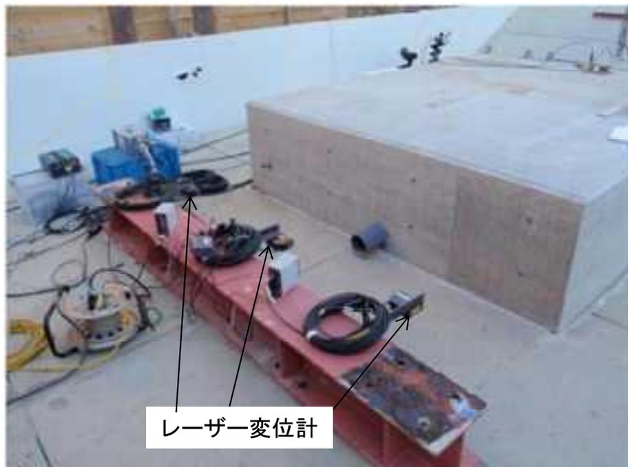
写真 5. 2. 1 レーザー変位計設置後の様子
