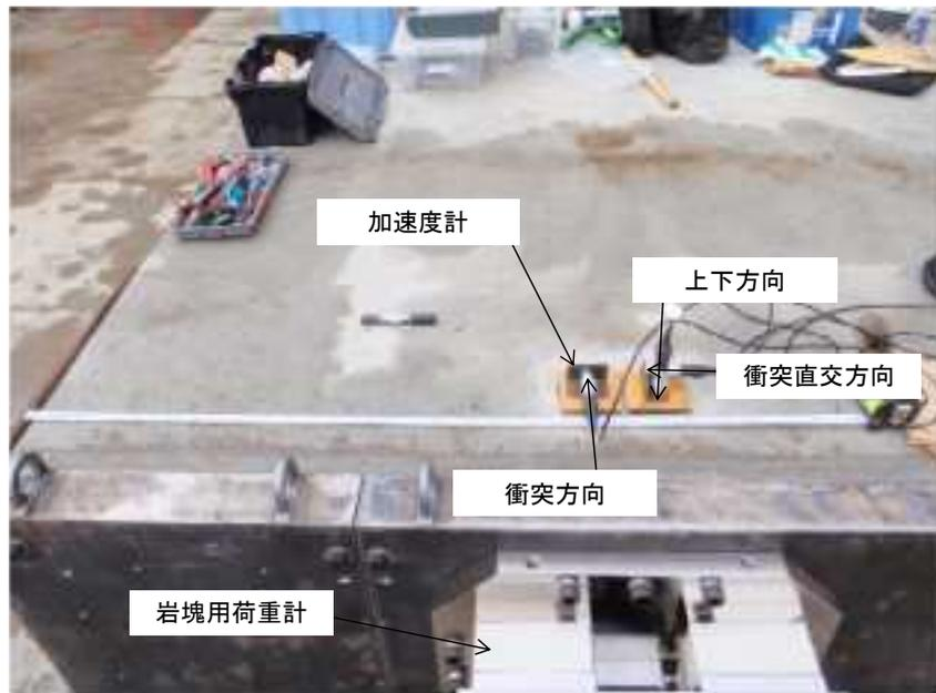
写真 5.3.1 加速度計設置後の様子
