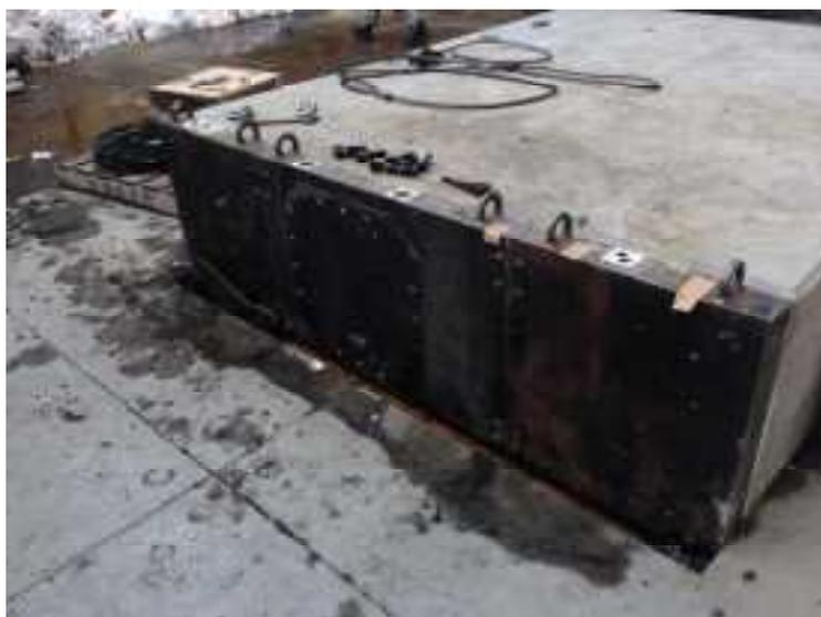
写真5.1.3 ロードセルベースを取り付けた様子
