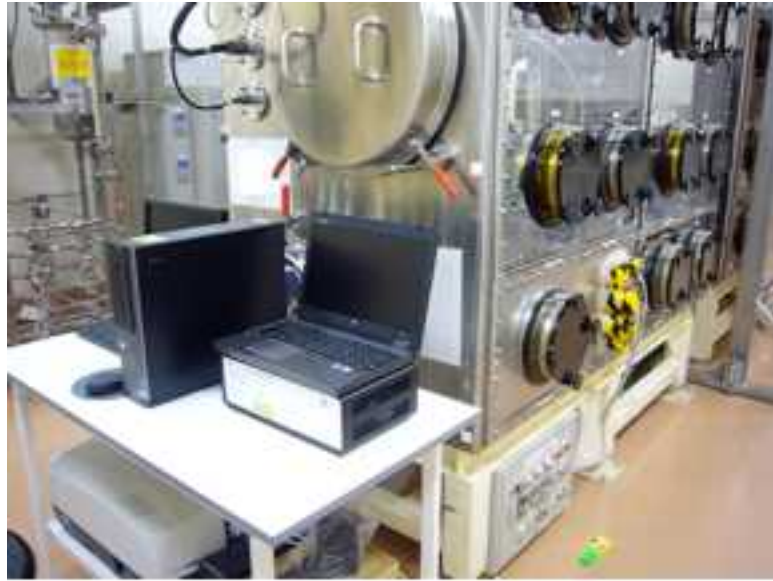
図 2.1.1-2 グローブボックスに設置した電気化学アナライザー及び分光光度計の外観
