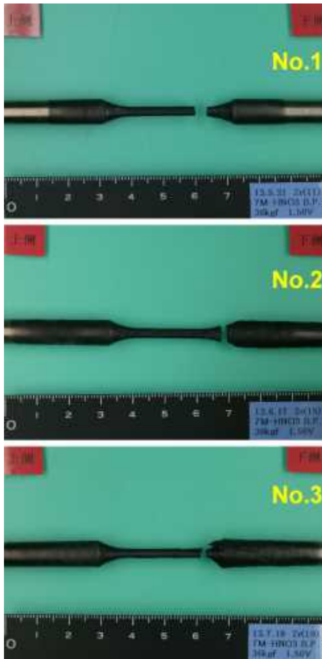
写真 2.1.2-2 定荷重引張試験後の試験片外観 (50 MPa)
