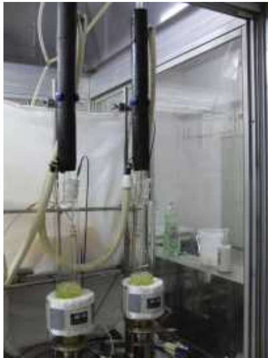
写真 3. 2. 1-1 減圧下伝熱面腐食試験装置の外観
