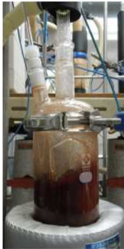
図 2. 4. 3-2 溶液および堆積層を減圧沸騰させた予備試験の様子
