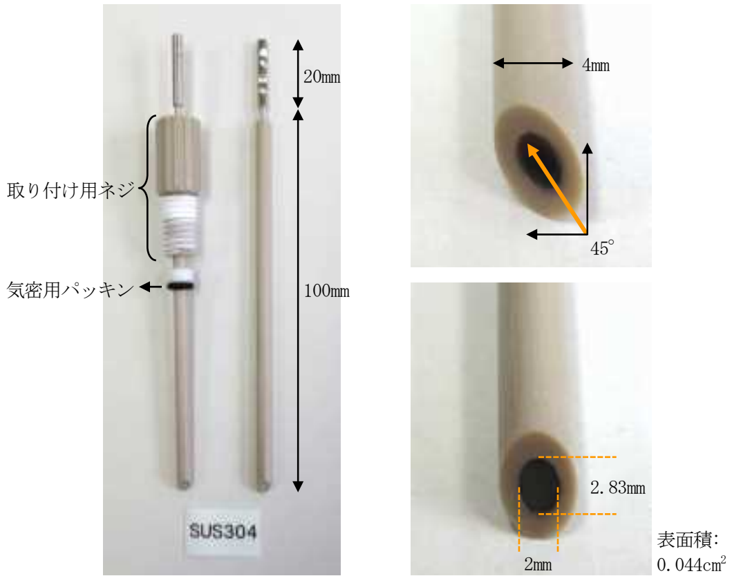
図 4.1-3 試験片の形状
