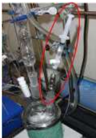
図 3.3.1 腐食試験液の注射器による採取装置例
