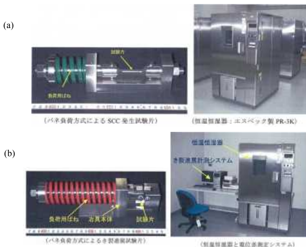
図 17 (a) 限界塩分量評価試験装置。(b) き裂進展試験装置 (23) 。
