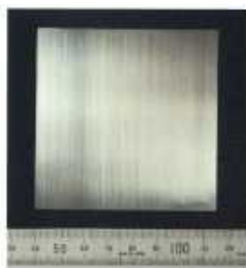
図 18 限界塩分量評価試験用平板試験片 (23)
