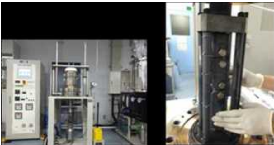
図10 1軸2連高温高圧腐食試験装置(東北大学)
