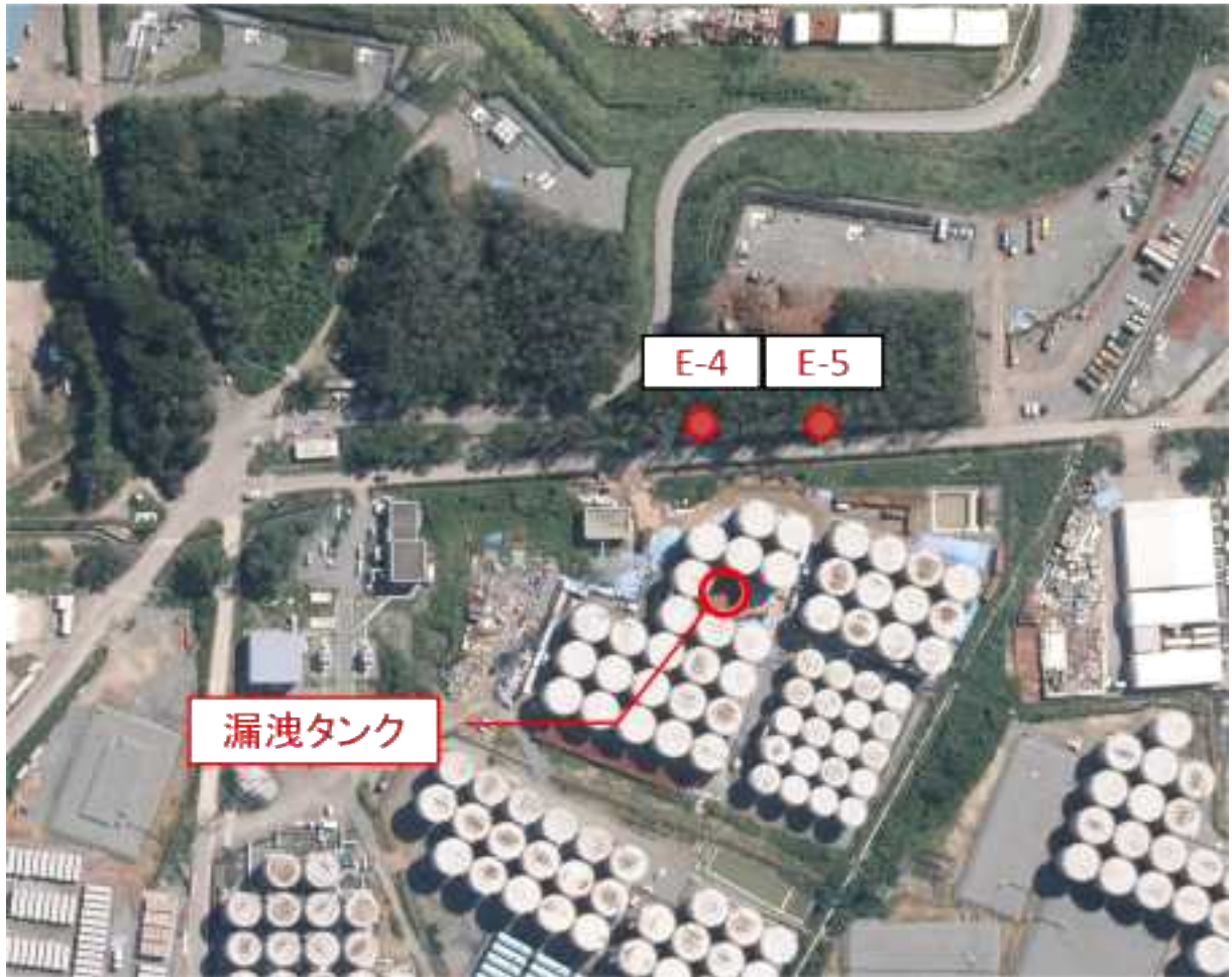
図 5.4-1 漏洩タンクと観測孔位置
