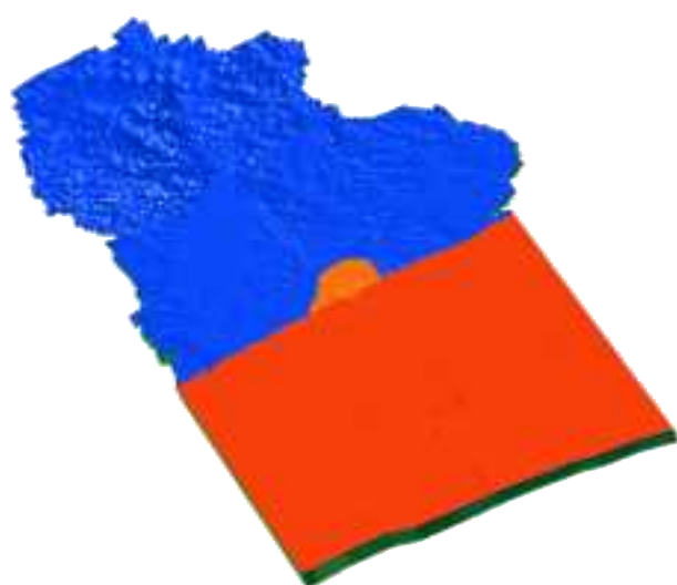
図 3.3-1 1F 広域モデル（東南東方向からの鳥観図、東西方向約 30km、南北方向約 10km、深度方向約 1km）
