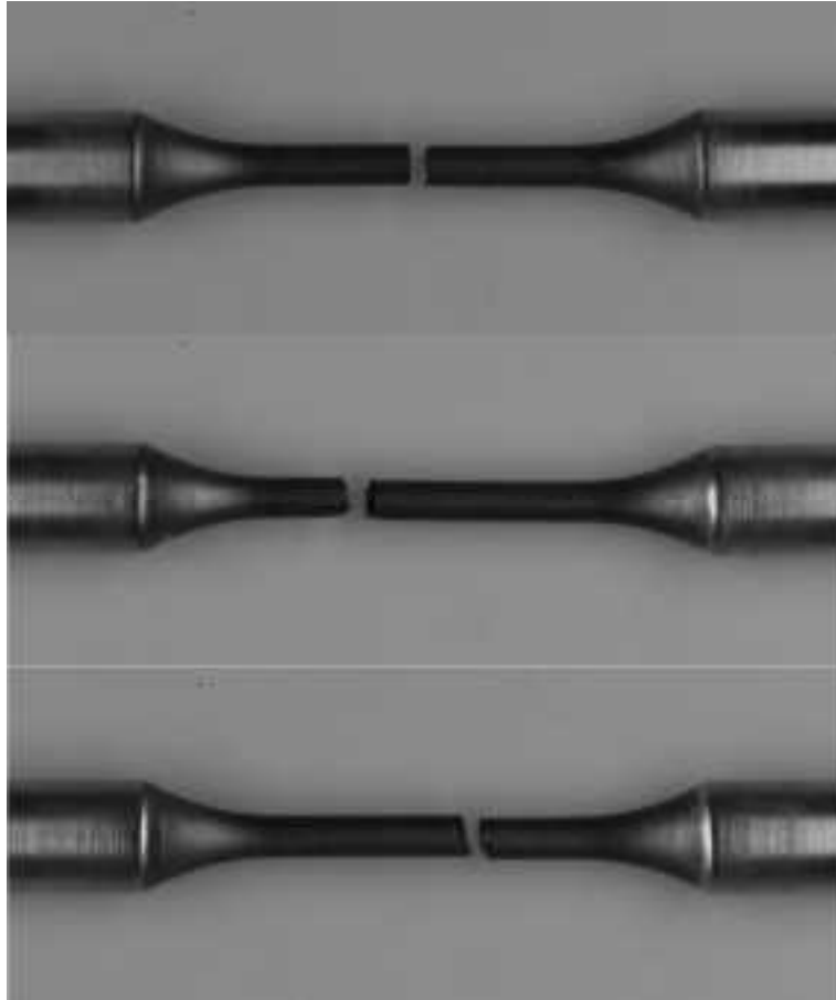
図 3. 1. 2-6(c) 試験後の試験片外観写真(1. 47V)
