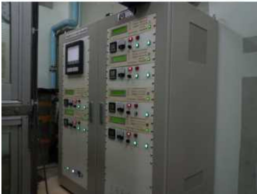
図 3.1.2-2 低ひずみ引張試験装置外観
