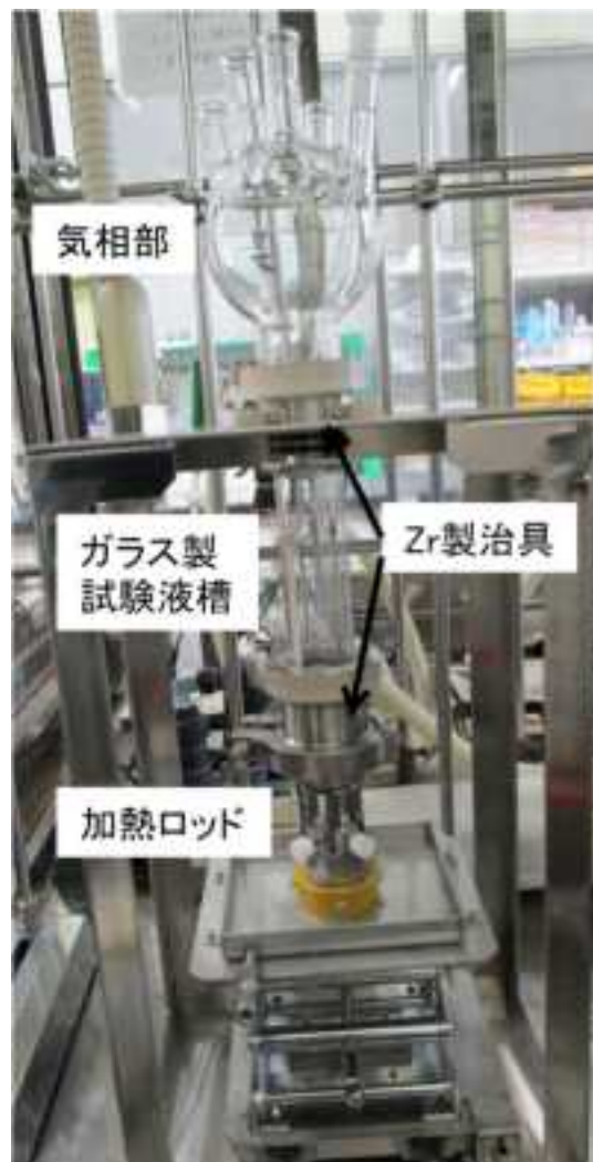
図 2. 2. 4-1 ホット用伝熱面腐食試験装置
