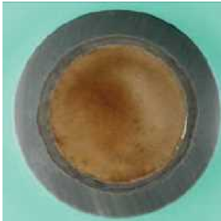
図 2. 2. 3-11 実際の実験による腐食面の様子
