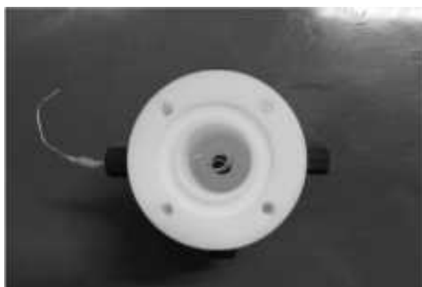
図 3. 2. 2-19 3 極式電気化学セルの模式図 (上図) および外観 (下図)
