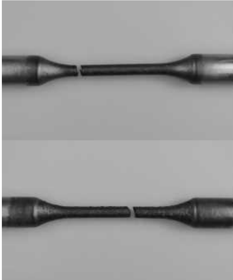
図 3.1.2-6(f) 試験後の試験片外観写真(1.44V)
