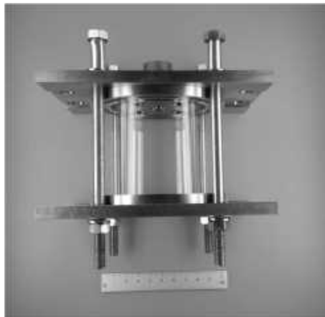
図 3. 2. 1-3 ガンマ線照射用試験セル外観
