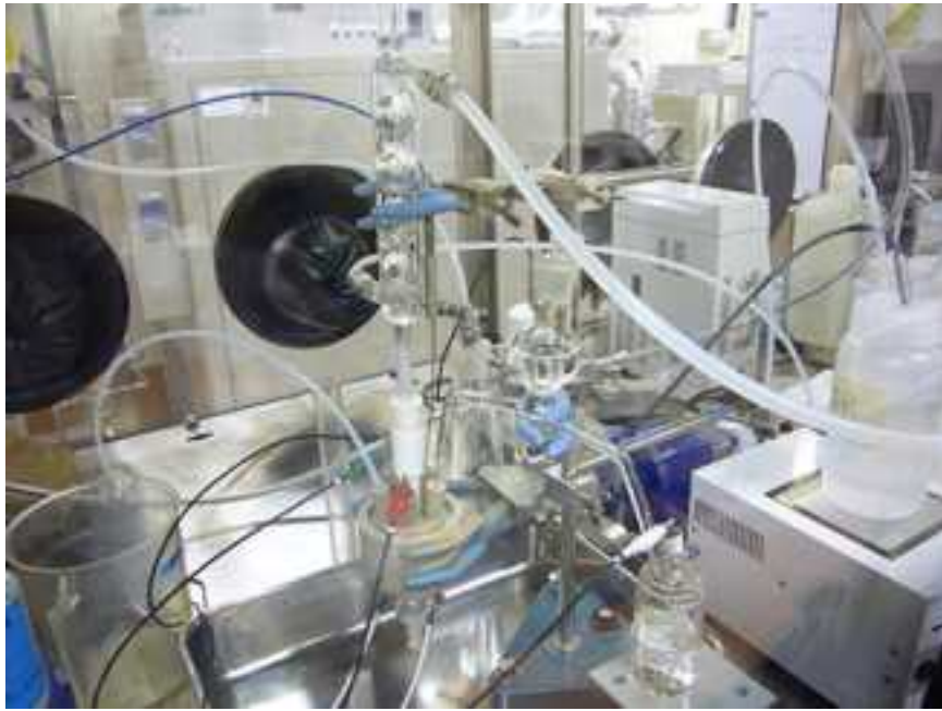
図 3. 1. 1-1 電気化学試験装置の外観
