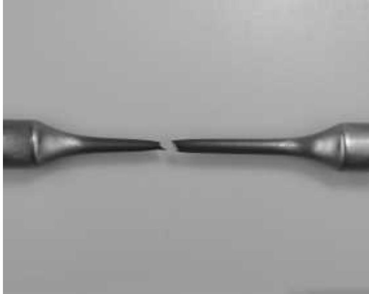
図 3. 1. 2-6(h) 試験後の試験片外観写真(1.38V)
