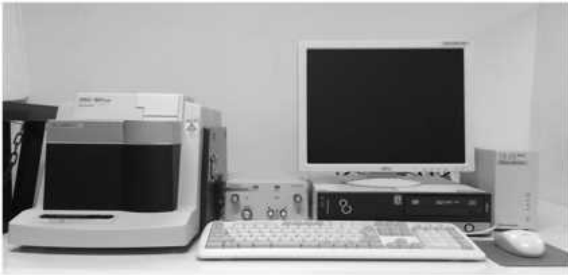
図 3. 2. 2-9 整備した示差熱分析装置外観
