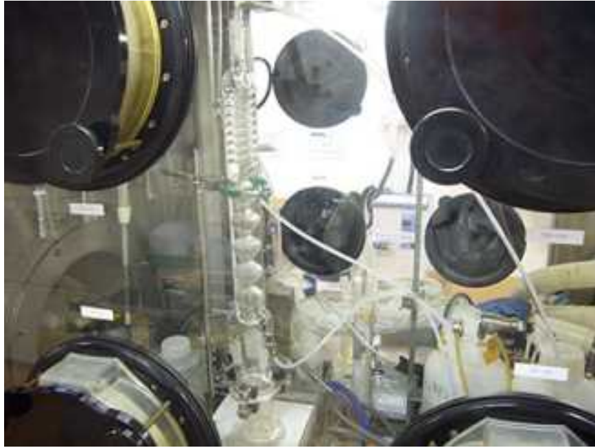
図 3. 1. 1-16 材料浸漬試験装置の外観
