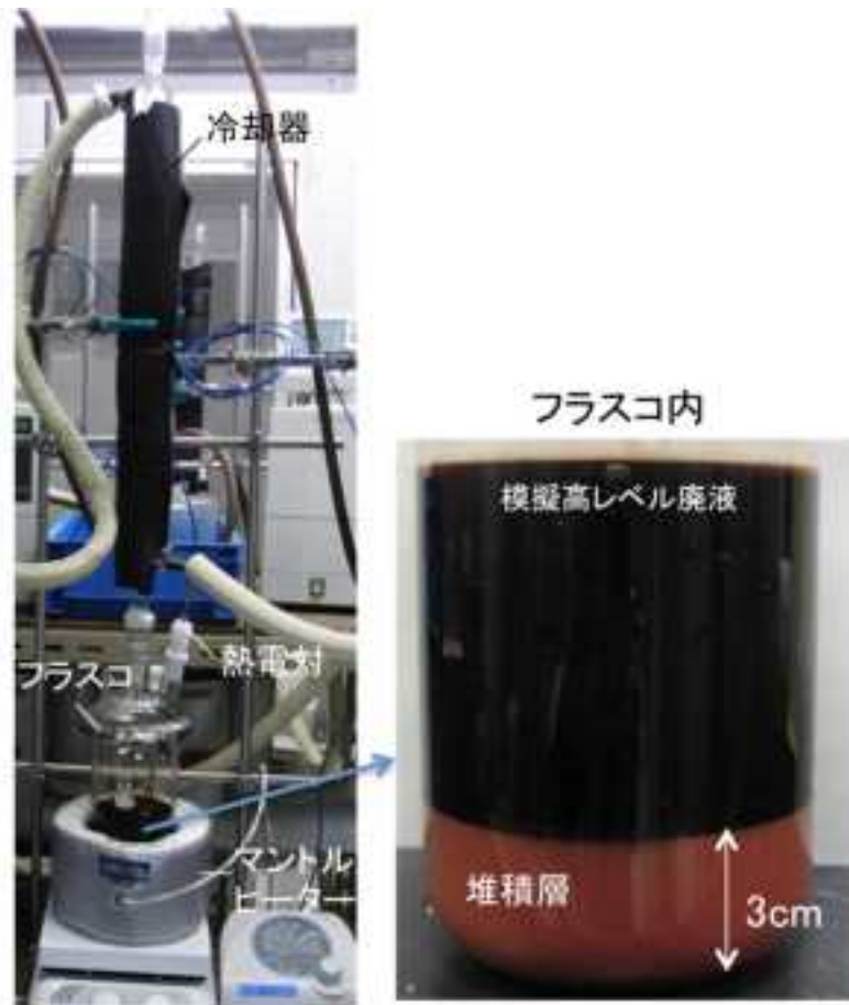
図 2.1.2-1 減圧浸漬腐食試験装置の外観写真
