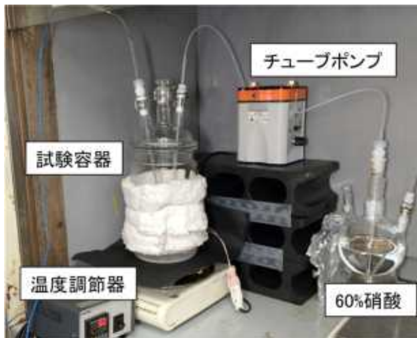
図 2. 1. 1-2 酸添加法の試験装置外観
