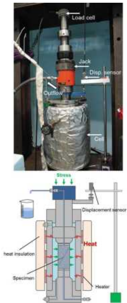
図 3.2.2.2-13 持続荷重せん断透水試験の外観・模式図.
