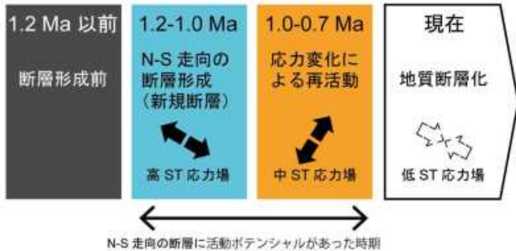
図 1.2.1.2-18 外房地域における最近 100 万年間の応力の時間変化と南北走向の地質図規模の断層の活動の関係。 南北走向の断層に活動ポテンシャルがあった時期は 1.2～0.7 Ma 頃に限定される。現在は活断層ではないと考えられている。
