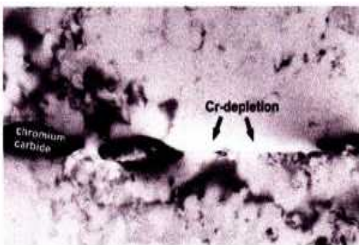
図5. 2-10 粒界に形成されたCr欠乏層の一例
