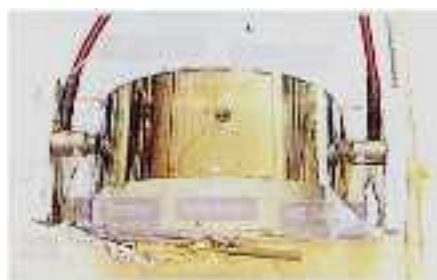
図 4.21 曲げ薄板の塩化マグネシウム液滴による SCC からの連続 AE 検出法。
