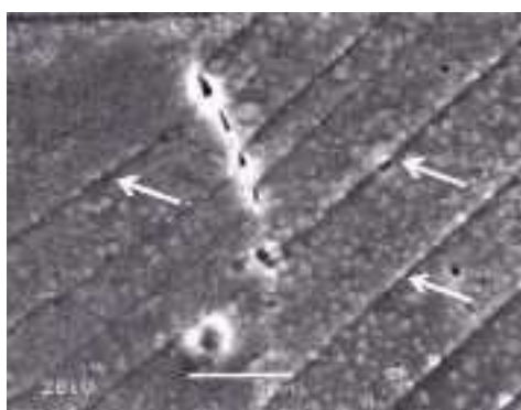
図7. 2-9 粒界と転位チャンネルの交差により形成されたマイクロボイド
