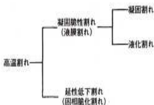
図5.2-1 溶接凝固時に形成される高温割れ
