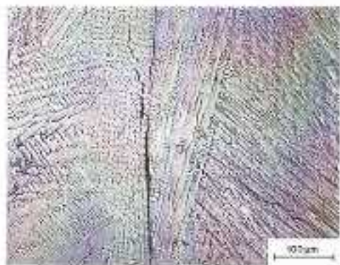
図5.2-2 凝固組織間の凝固割れ
