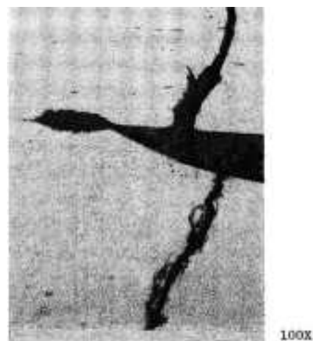
(b) 隙間内酸化物の膨張による応力で割れ発生
