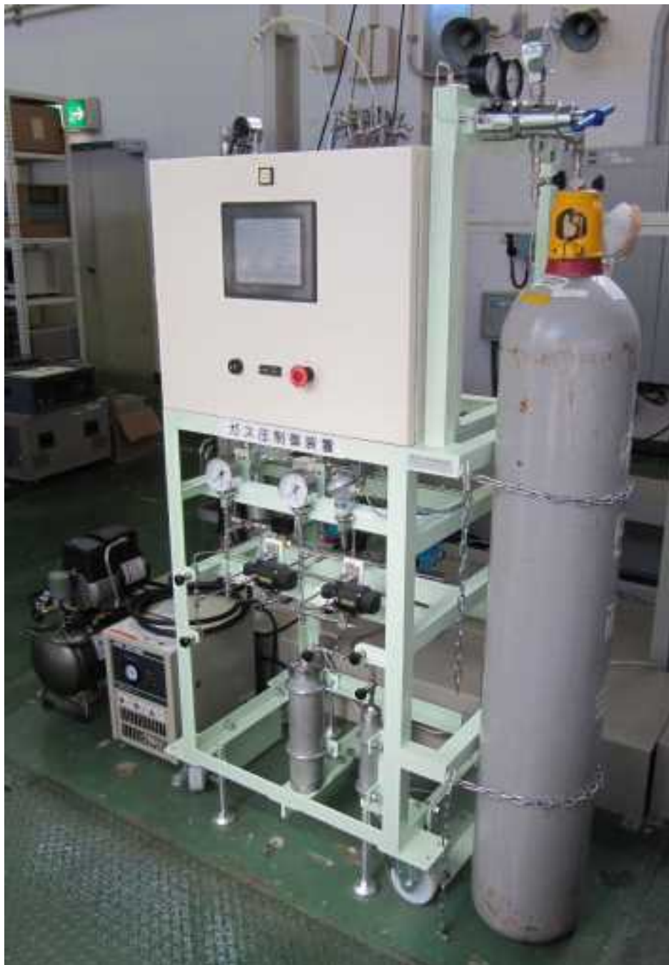
図 5.3.8-6 ガス圧制御装置の外観写真
