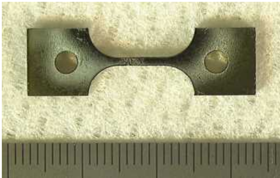
290°Cで 2%(目標値)までひずみ付与した引張試験片(TT02)
