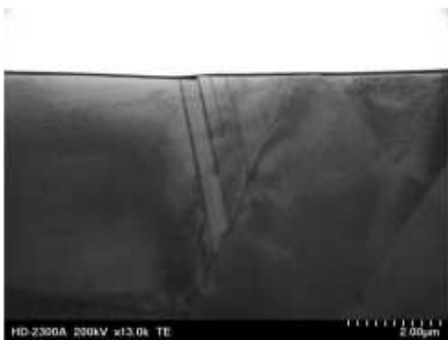
図 5.2.4-35(1) TT01(試験温度：室温、ひずみ大、粒界ステップ小)のマイクロ組織
