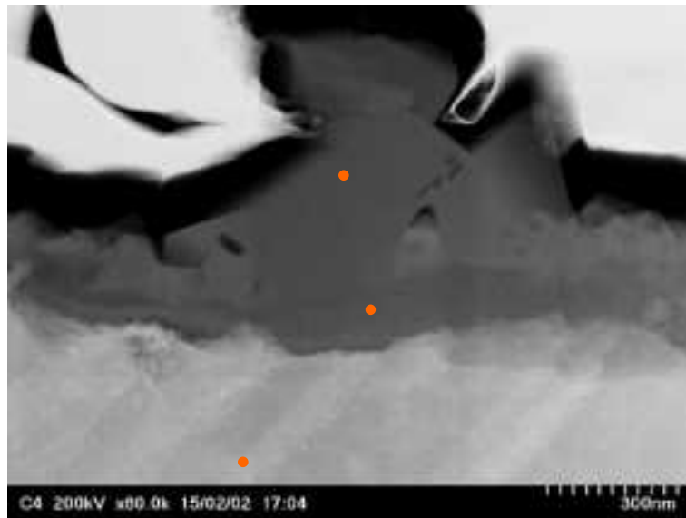
(2)領域①の STEM モードでの Z コントラスト像(橙色点:EDX 分析点)
