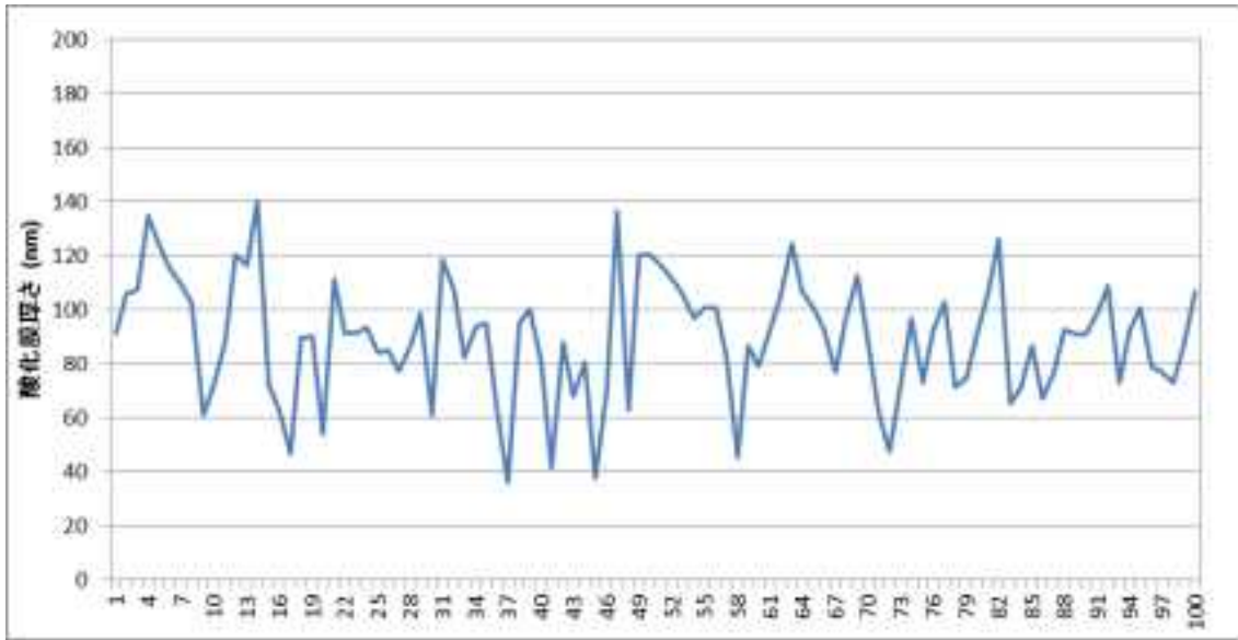
図 5.2.4-61 A440(0.1%ひずみ付与材)の酸化皮膜厚さ
