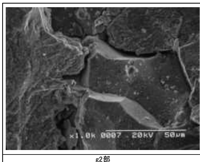
写真 5.2.3-7(g) 破面 SEM 観察写真(g 部拡大)
