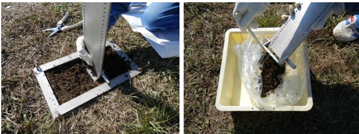
図 E.7 スクレーパープレートによる土壌採取
