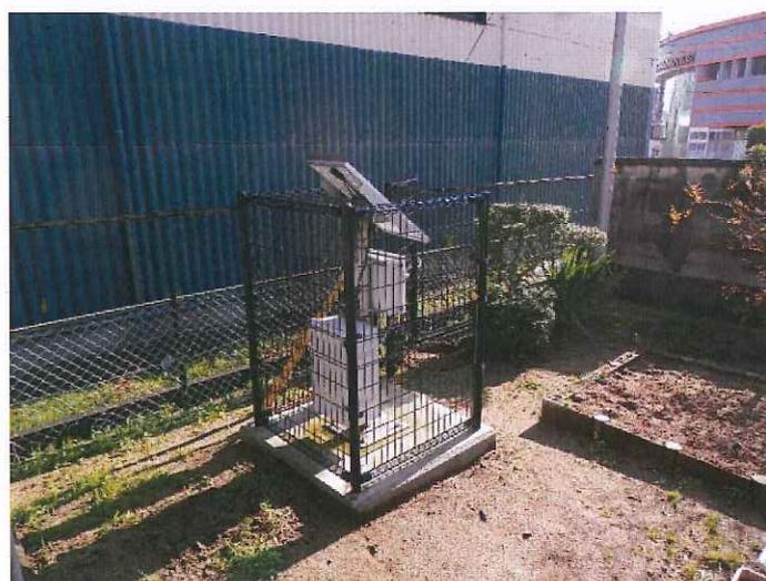
図 4.2 簡易型電子線量計（背面から）
