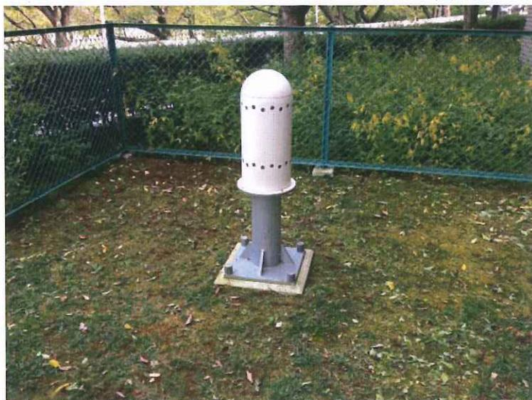
図4.9 路地上 地上高1 m 設置状況の一例（愛知県）
