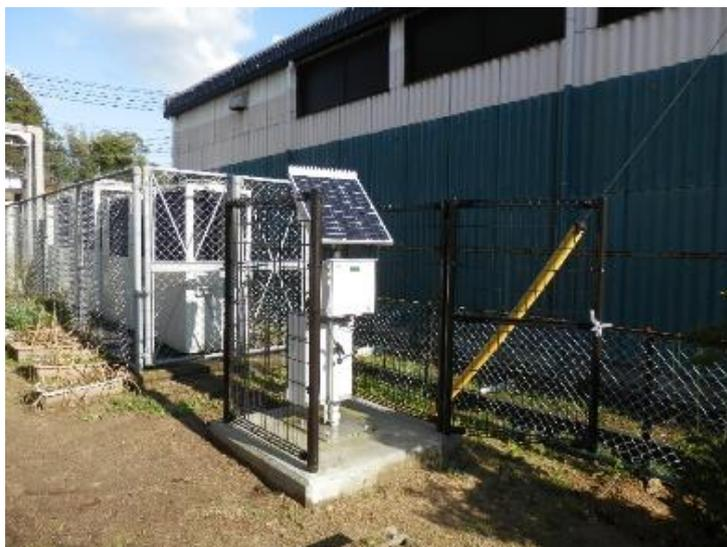
図 5.5 簡易型電子線量計 設置状況の一例（島根県）
