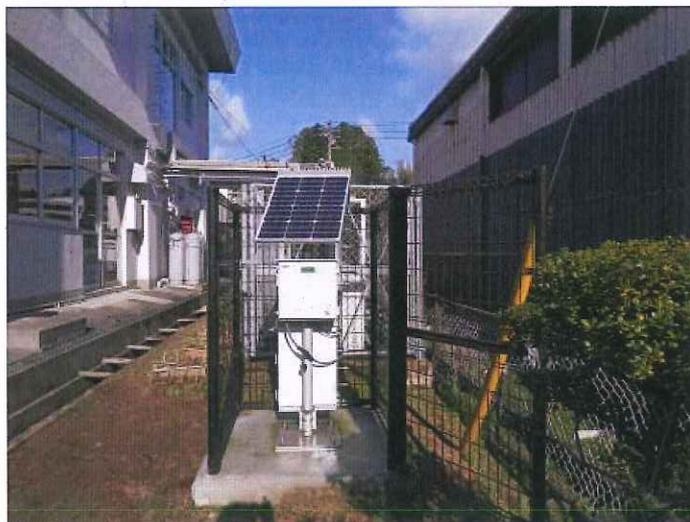
図 4.1 簡易型電子線量計（前面から）
