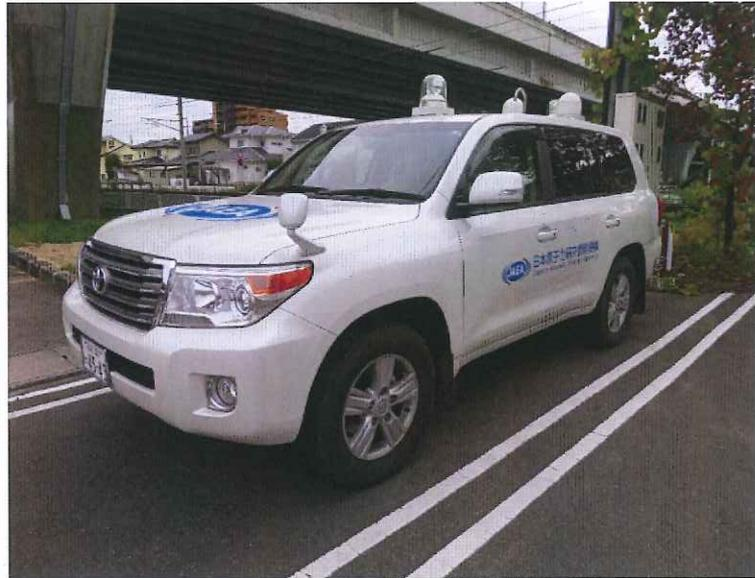
図4.5 日本原子力研究開発機構所有のモニタリングカー
