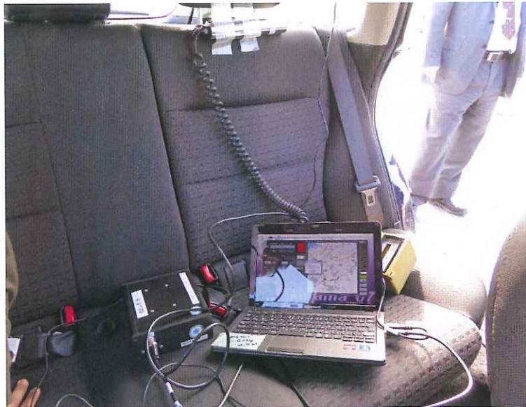
図4.3 KURAMAを車両に搭載した様子
