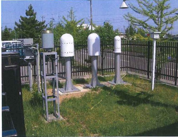
図 4.10 路地上 地上高 1.5~1.8 m 設置状況の一例（青森県）
