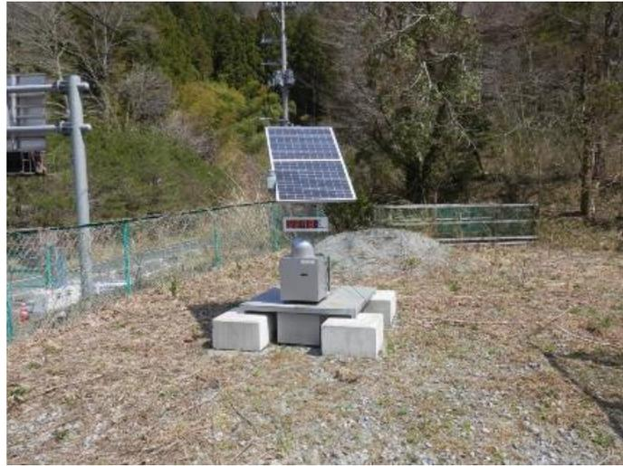
図 5.6 可搬型モニタリングポスト 設置状況の一例
