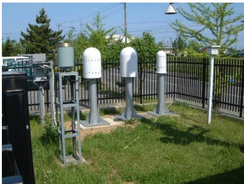
図 5.2 路地上 地上高 1.5~1.8 m 設置状況の一例（青森県）
