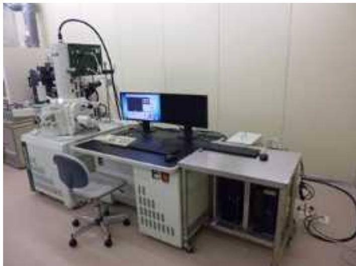
図-3.3 : 走査型電子顕微鏡の外観写真
