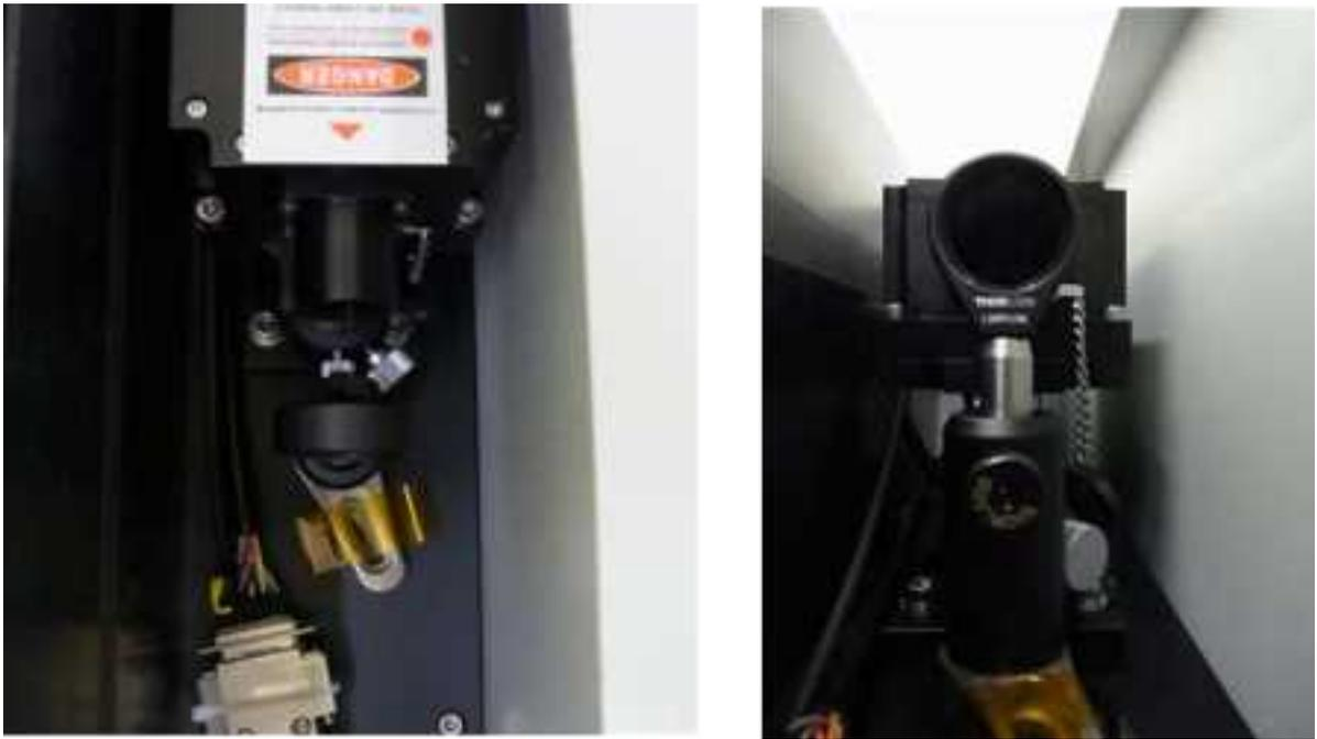
図-5.18 : レーザーパワー調整機構
