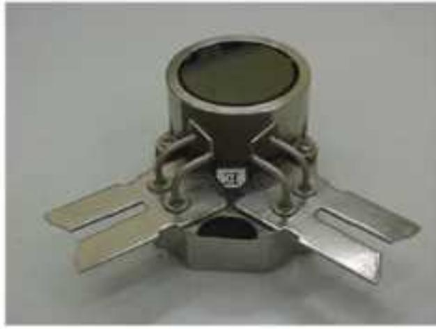
図-5.12 : 電子顕微鏡用試料ホルダー
