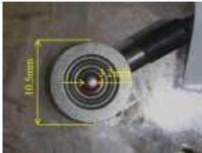
図-3.4.1(1)-5 実験に用いたロードセル
