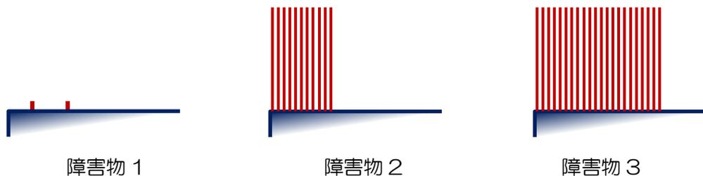
図 II.3.5-1 障害物模型の設置模式図
