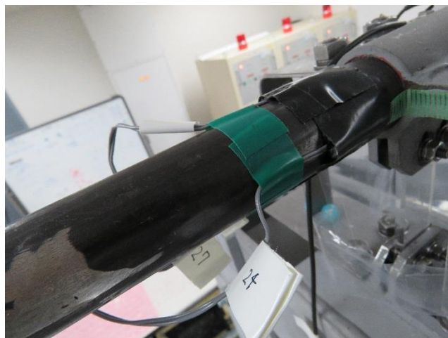
歪ゲージの設置状況
