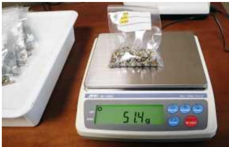
図 8-4 電子天秤による礫分の秤量
