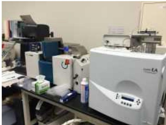
図 8-6 直接同位体分析用質量分析計 (左) と Elemental Analyzer (右)
