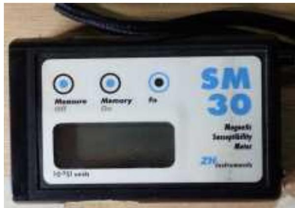
図 8-3 SM-30 型携帯帯磁率計
