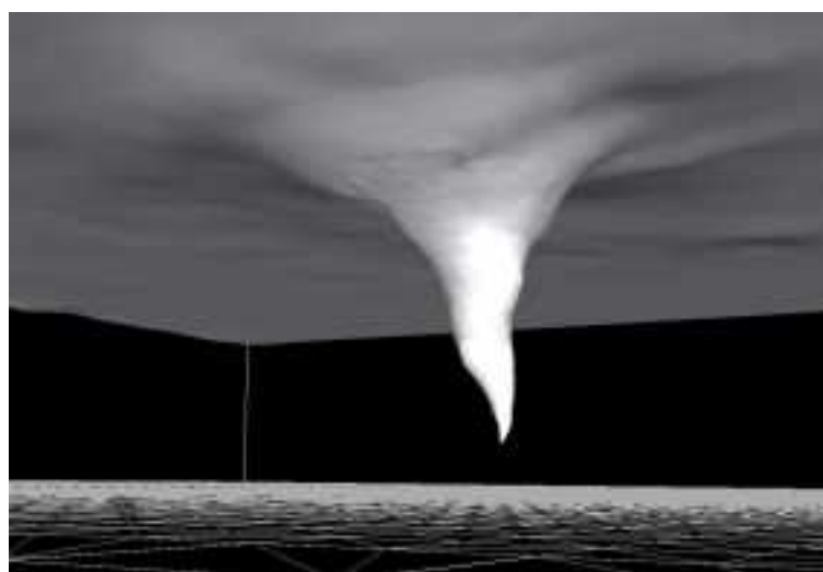
図 2.5.7 漏斗雲として可視化した瞬間流れ場 ( t=47790\text{s} , RH=30\% , U_{\text{tmax}}=105\text{m/s} 相当に圧力場を補正)
