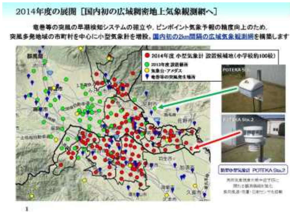
図 2.3.5 地上稠密気象観測網（POTEKA）の配置図（明星電気）
