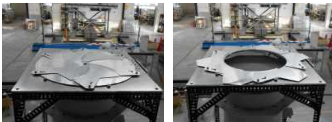
図 4.3.4 瞬発的噴流を再現するためのシャッター(左:閉まった状態, 右:開いた状態)
