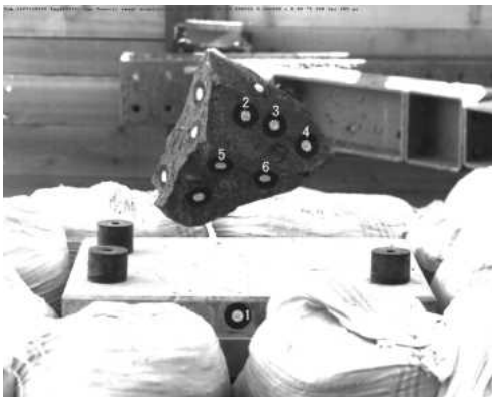
図 3.3.2.69 CaseB No.2 試番 101 実岩塊 20cm 落下高さ 1m
