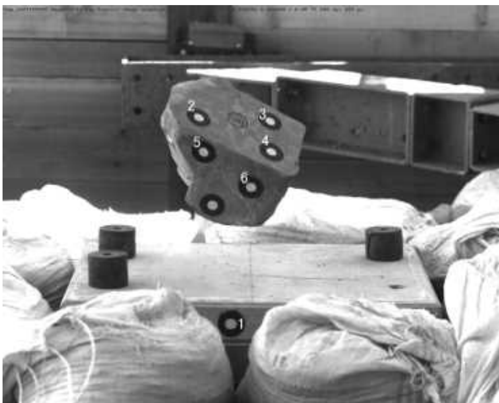
図 3.3.2.74 CaseB No.42 試番 96 多面体 20cm 落下高さ 1m
