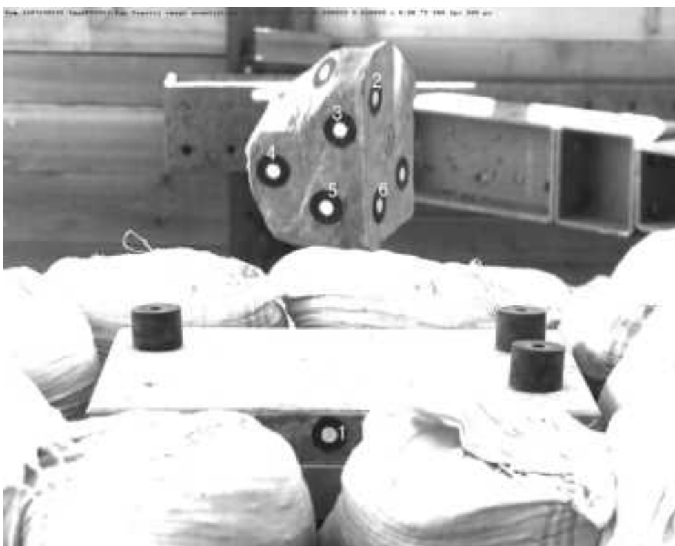
図 3.3.2.76 CaseB No.59 試番 98 多面体 20cm 落下高さ 4m
