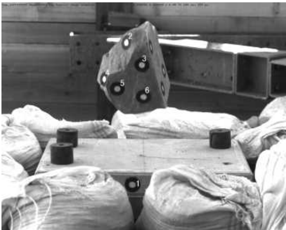
図 3.3.2.75 CaseB No.56 試番 97 多面体 20cm 落下高さ 3m
