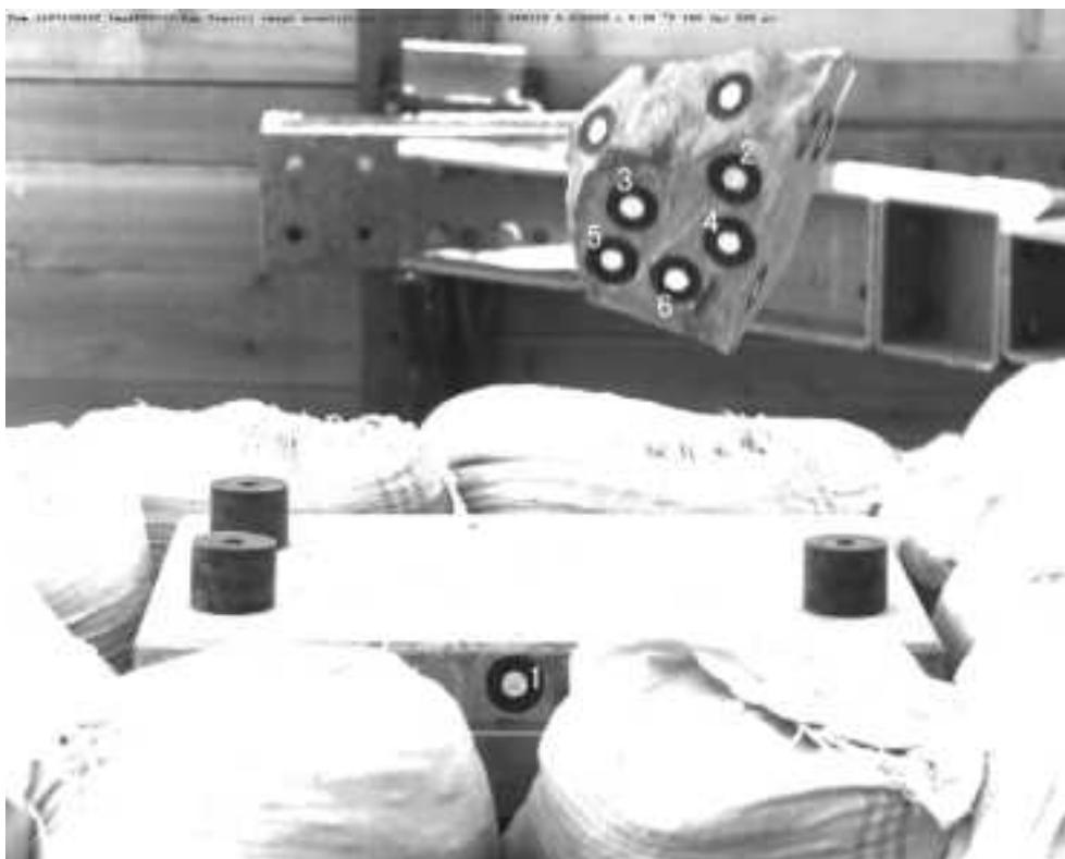
図 3.3.2.77 CaseB No.60 試番 99 多面体 20cm 落下高さ 5m
