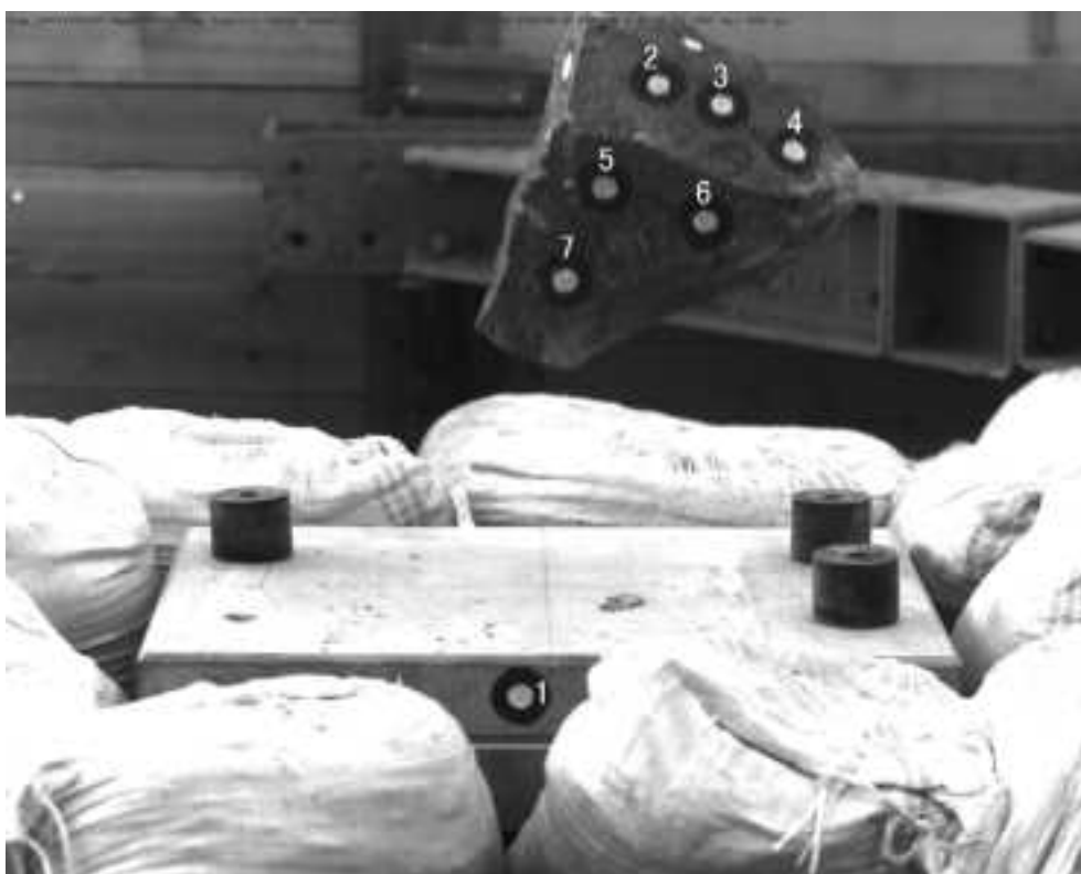
図 3.3.2.72 CaseB No.19 試番 106 実岩塊 20cm 落下高さ 5m
