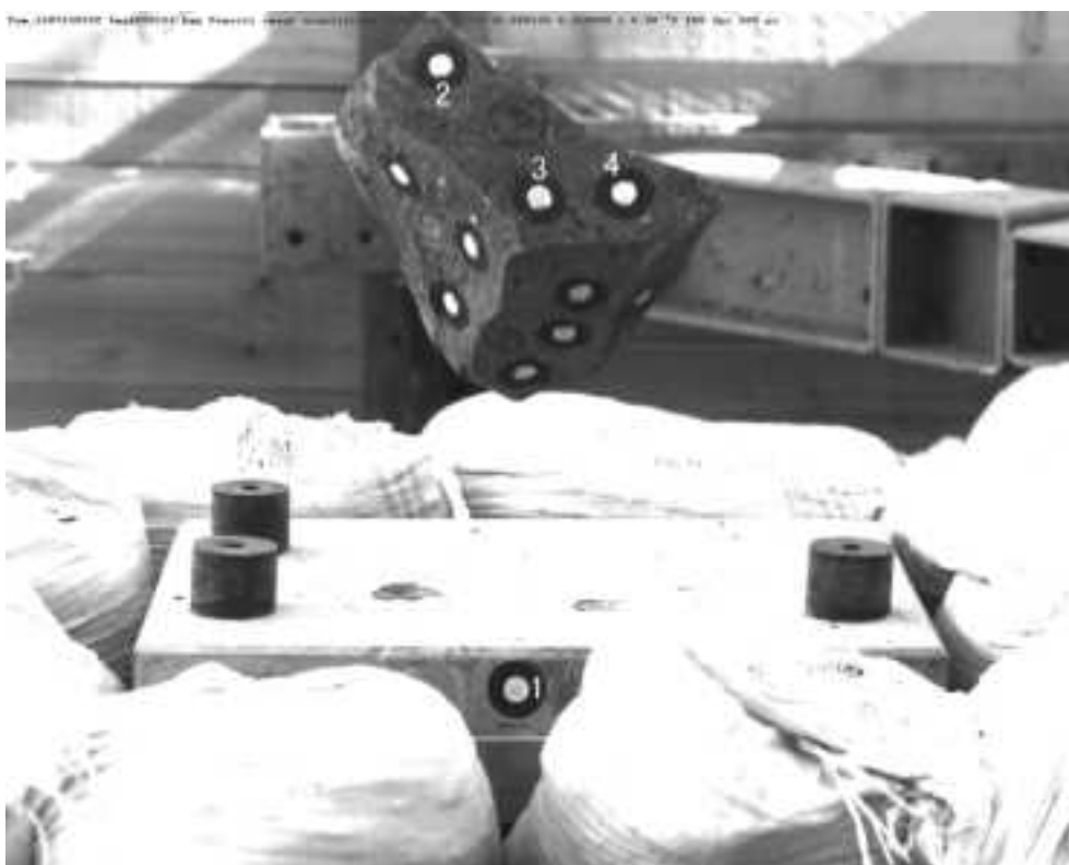
図 3.3.2.70 CaseB No.16 試番 103 実岩塊 20cm 落下高さ 3m
