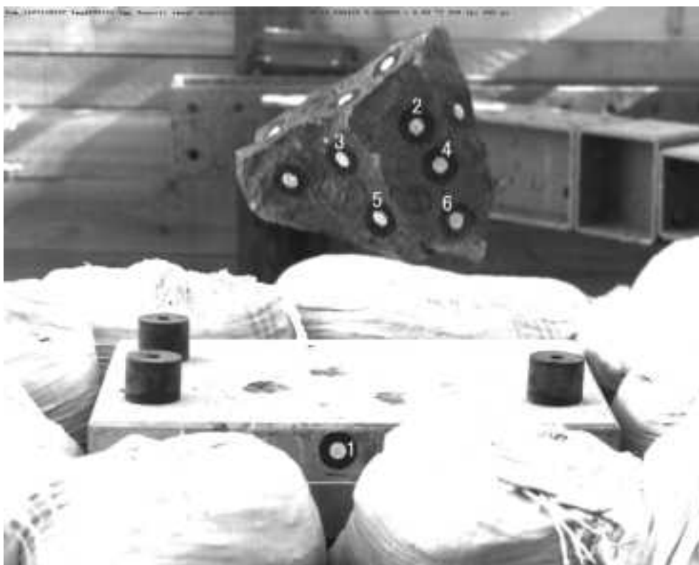
図 3.3.2.71 CaseB No.18 試番 104 実岩塊 20cm 落下高さ 4m
