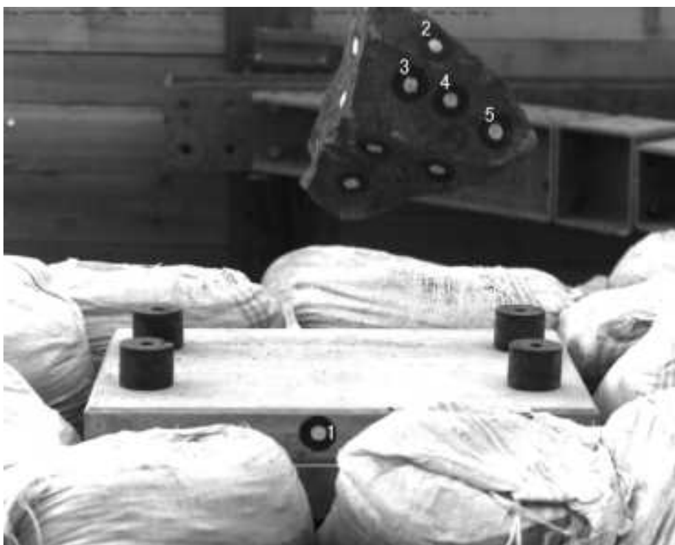
図 3.3.2.73 CaseB No.20 試番 107 実岩塊 20cm 落下高さ 5m
