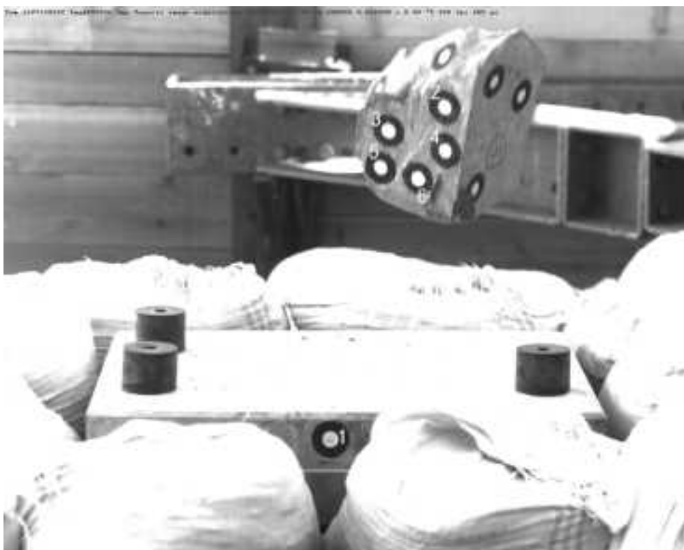
図 3.3.2.78 CaseB No.61 試番 100 多面体 20cm 落下高さ 5m
