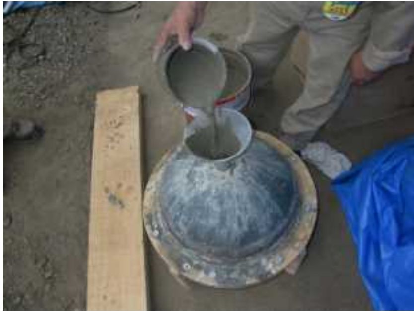
图 3.2.17 40cm 球状模型打設狀況
