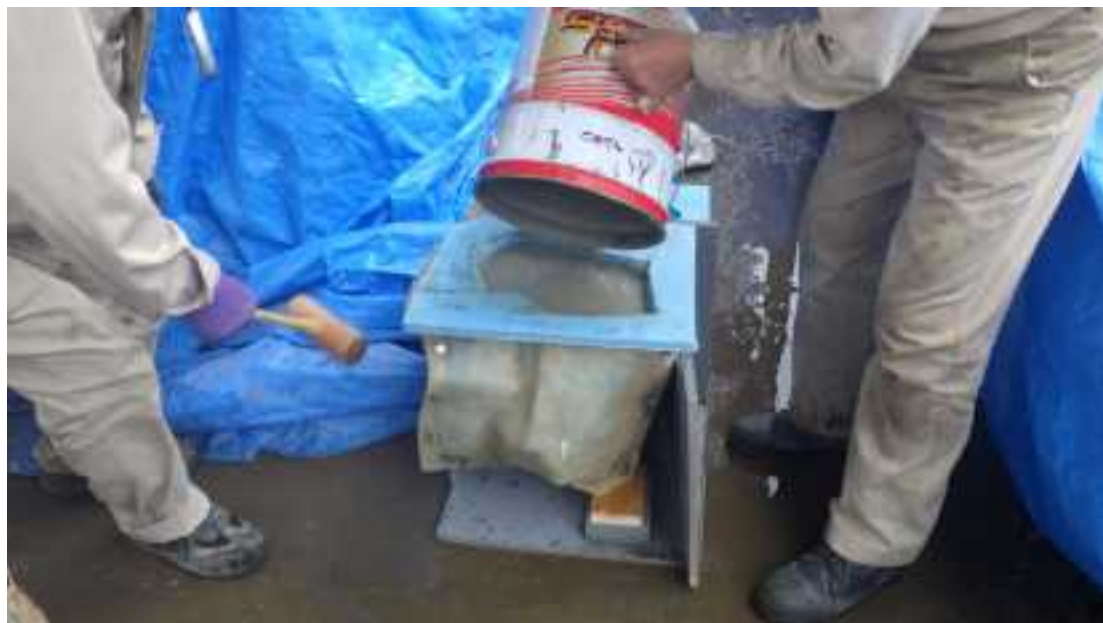
図 3.2.19 多面体 40cm 打設状況
