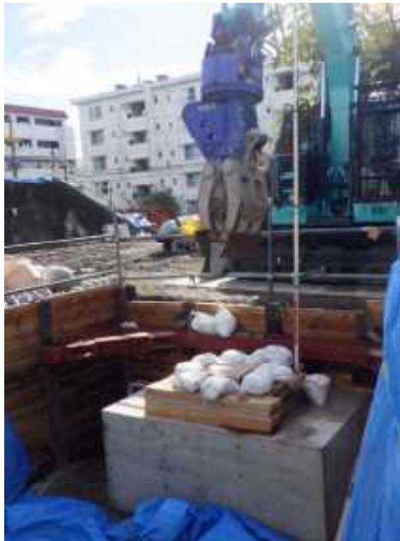
図 3.2.58 ベニヤ板 多面体岩塊模型 40cm 試験状況
