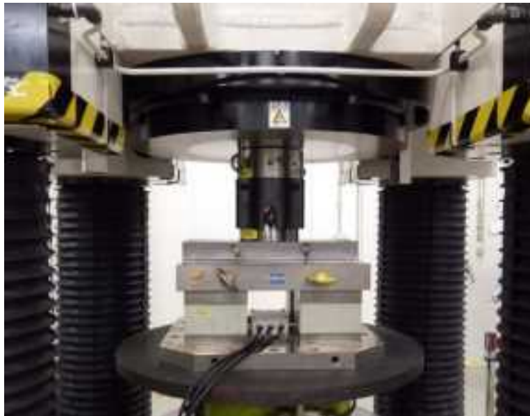
図 3.2.39 偏心荷重校正作業状況その 1
