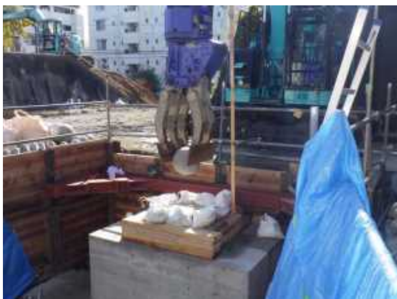
図 3.2.54 ベニヤ板 球状岩塊模型 40cm 試験状況
