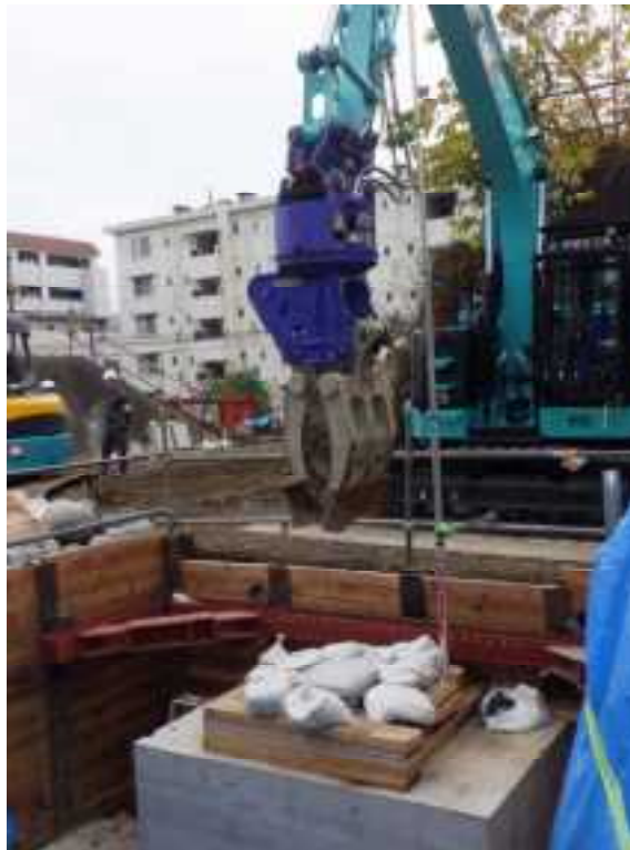
図 3.2.64 コンクリート板 球状岩塊模型 20cm 試験状況
