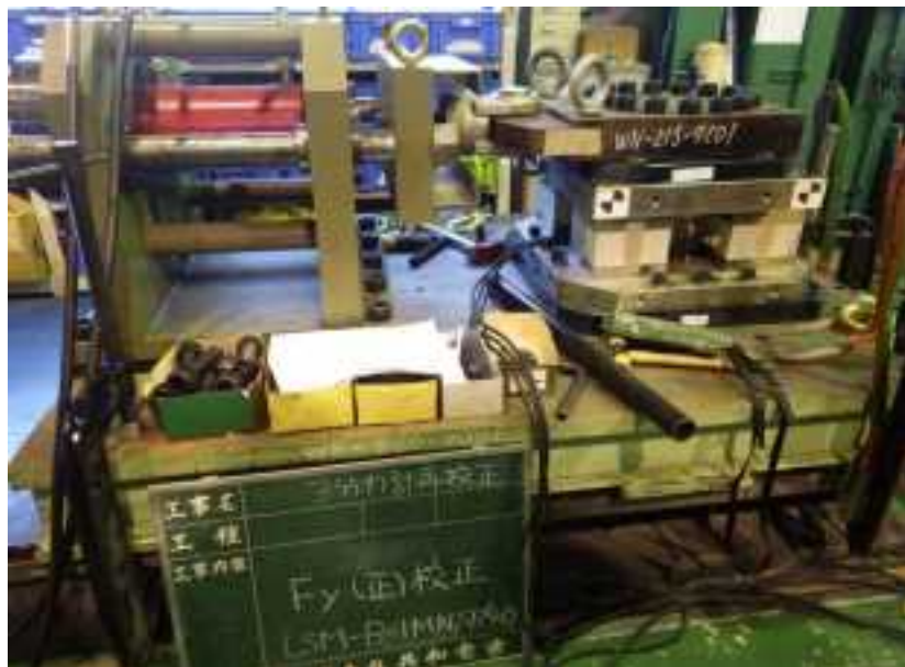
图 3.2.37 水平 Y 方向 (正) 校正作業狀況
