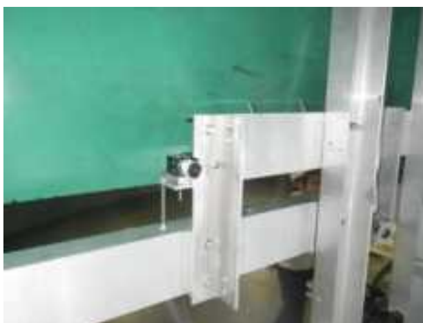
写真 3.1.44 ハイスピードカメラ設置状況 2
