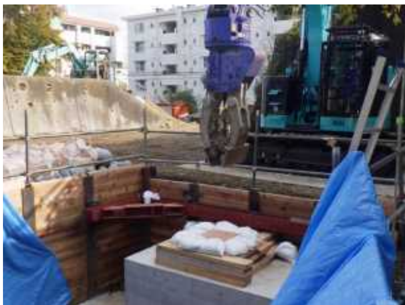
図 3.2.53 ベニヤ板 球状岩塊模型 20cm 試験状況
