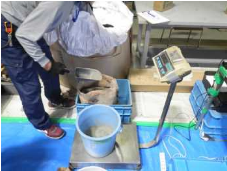
写真 3.1.13 基盤層に使用するセメントの計量
