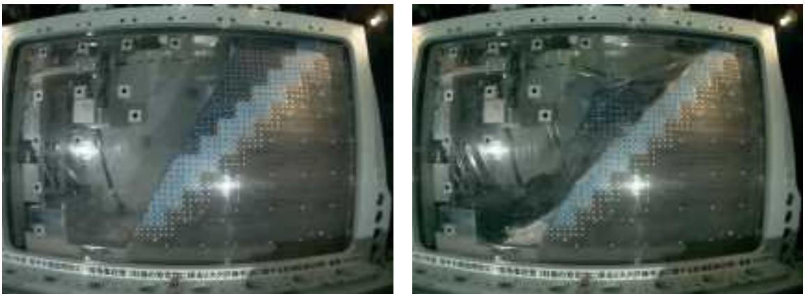
写真 3.1.50 ケース 33 の振動実験の状況 (写真左：加振前、写真右：加振後)
