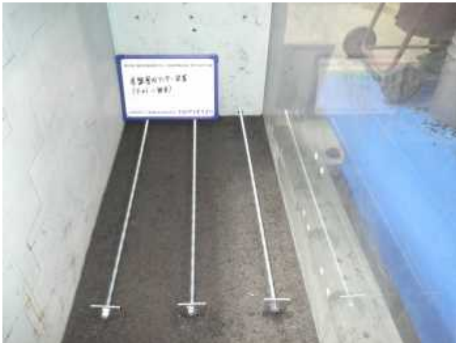
写真 3.1.22 剛体土槽を反力としたアンカー設置
