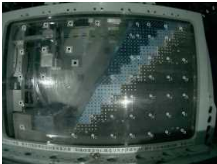
図 3.1.17 レンズゆがみ補正に用いた標点 (ケース 32,33 共通)
