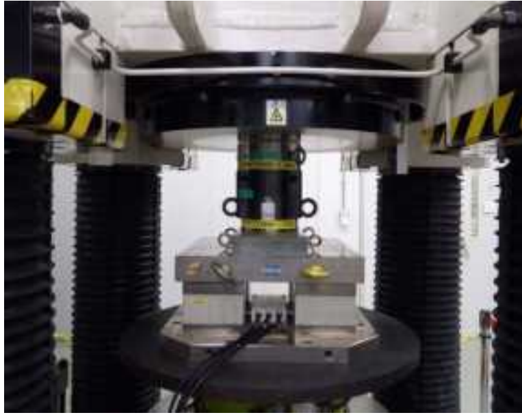
図 3.2.40 偏心荷重校正作業状況その2
