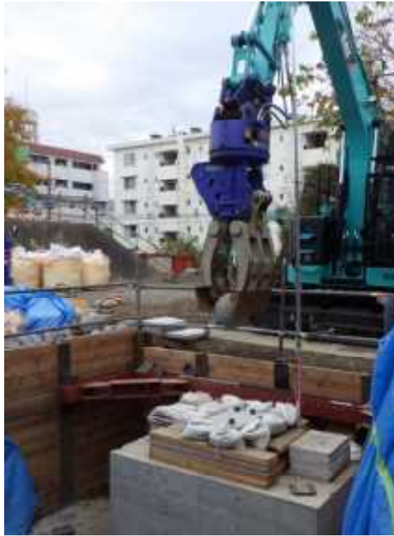
図 3.2.65 コンクリート板 球状岩塊模型 40cm 試験状況
