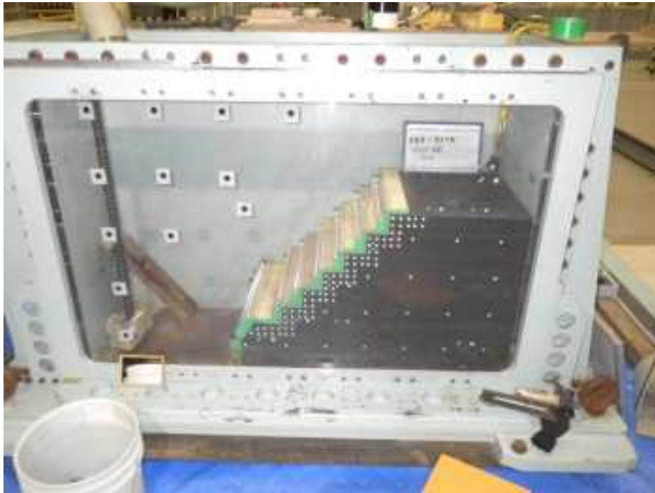
写真 3.1.23 基盤層の作製状況
