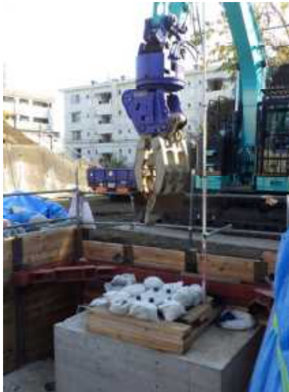
図 3.2.69 コンクリート板 多面体岩塊模型 40cm 試験状況
