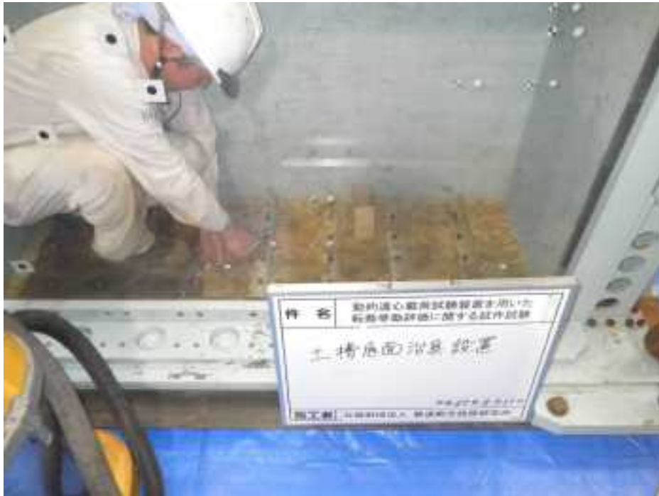
写真 3.1.21 土槽底面に剛結した等辺山形鋼
