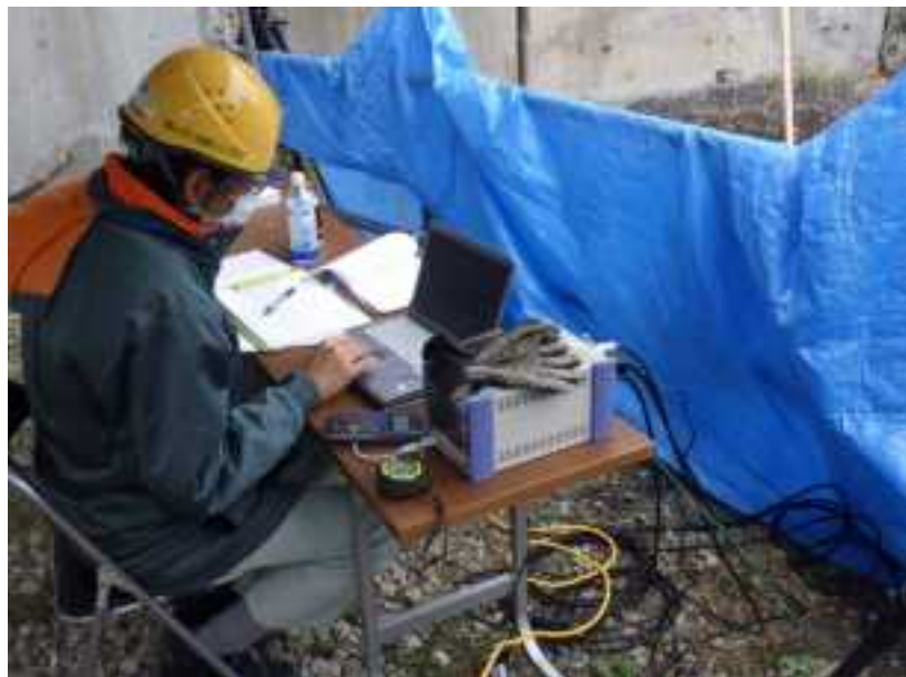
図 3.2.52 落下荷重計測状況
