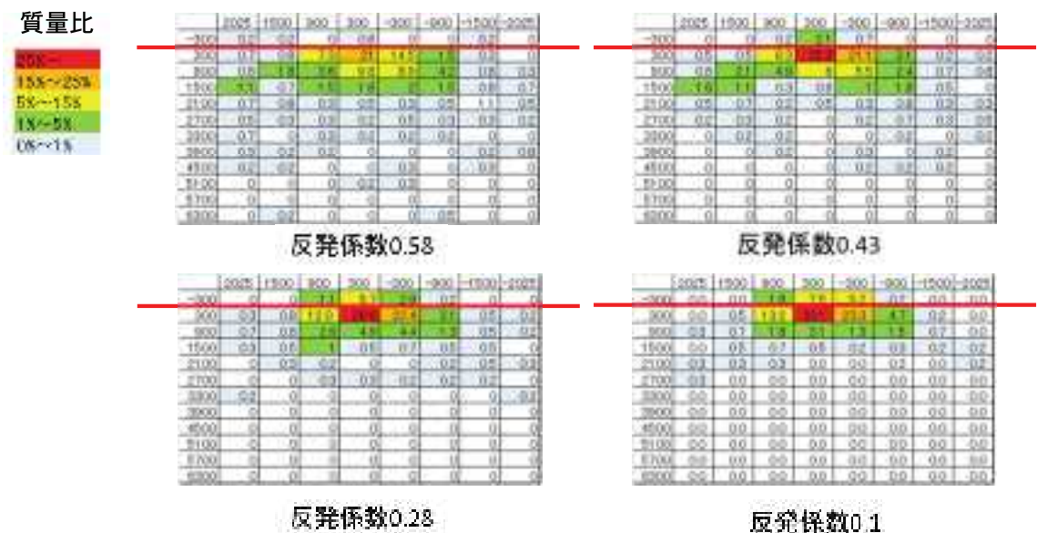
図 2.5-3 シミュレーション、反発係数による堆積状態の差
