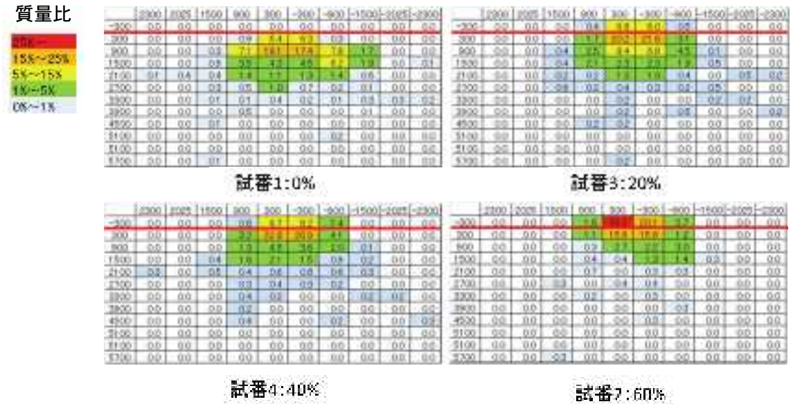
図 2.5-1 実験、細粒分含有率による堆積状態の差
