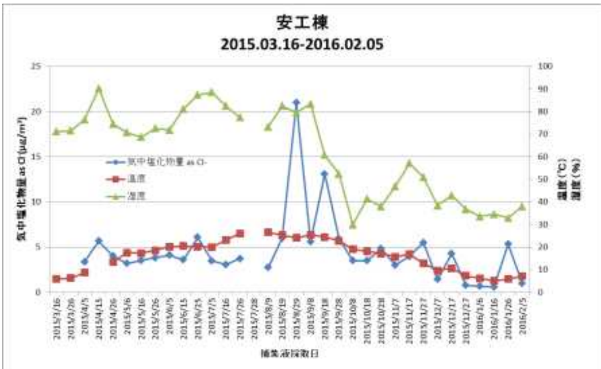
図 3.3.2-2 捕集液から求めた気中塩化物量 as Cl - と温度・湿度 (安工棟)。7月28日は積算流量が少なかったため欠損とした。
