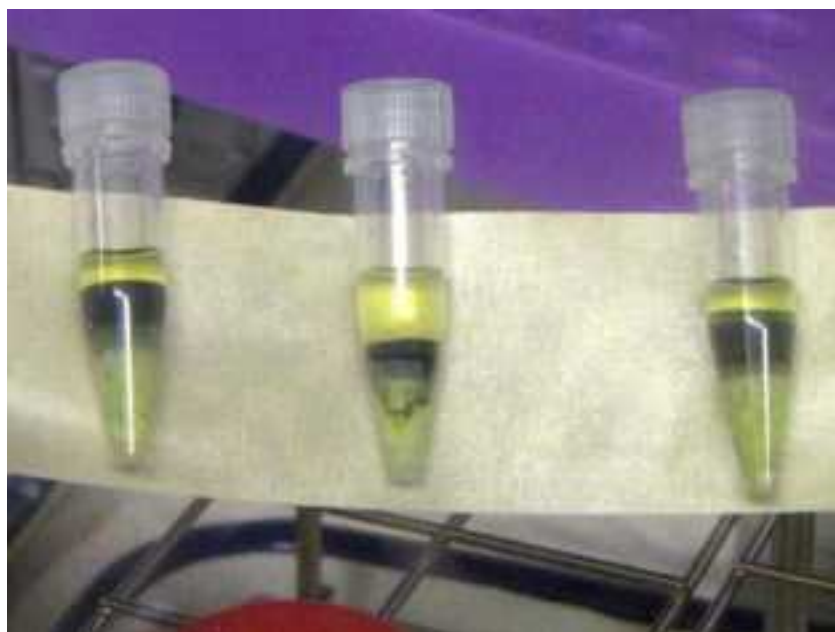
図 4.2-4 遠心分離前の沈殿生成状況 (左からケース 1、2、3)
