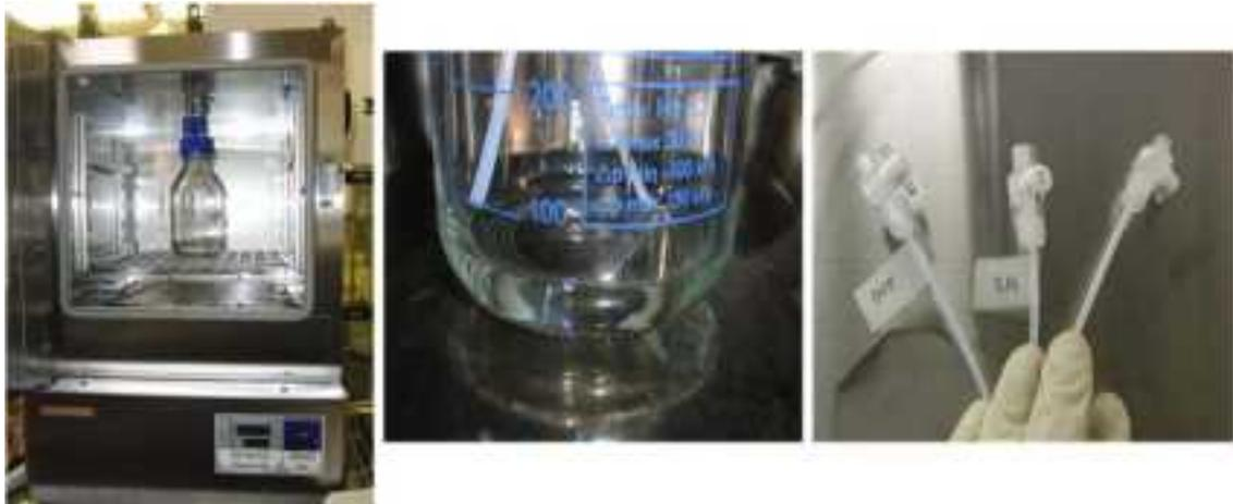
图 2.1.2-9 气相共存閉鎖系 V(IV)-V(V) 化学平衡 NO<sub>x</sub> 测定試験装置写真
