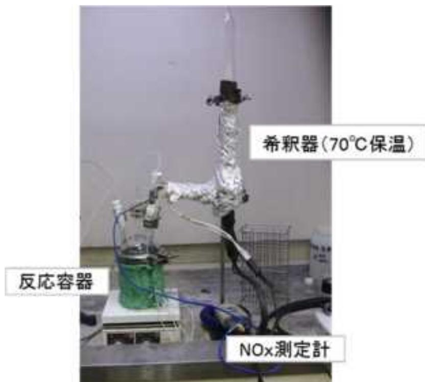
図 2. 1. 2-2 連続バブリング試験装置写真
