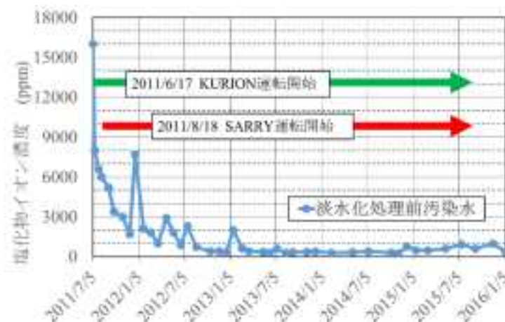
図 2.1-17 淡水化処理前汚染水に含まれる塩化物イオン濃度の変化
