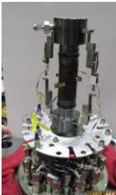
図 4.2.2.6-2 室内三軸透水試験内での軸方向及び周方向の変位計の設置状況
