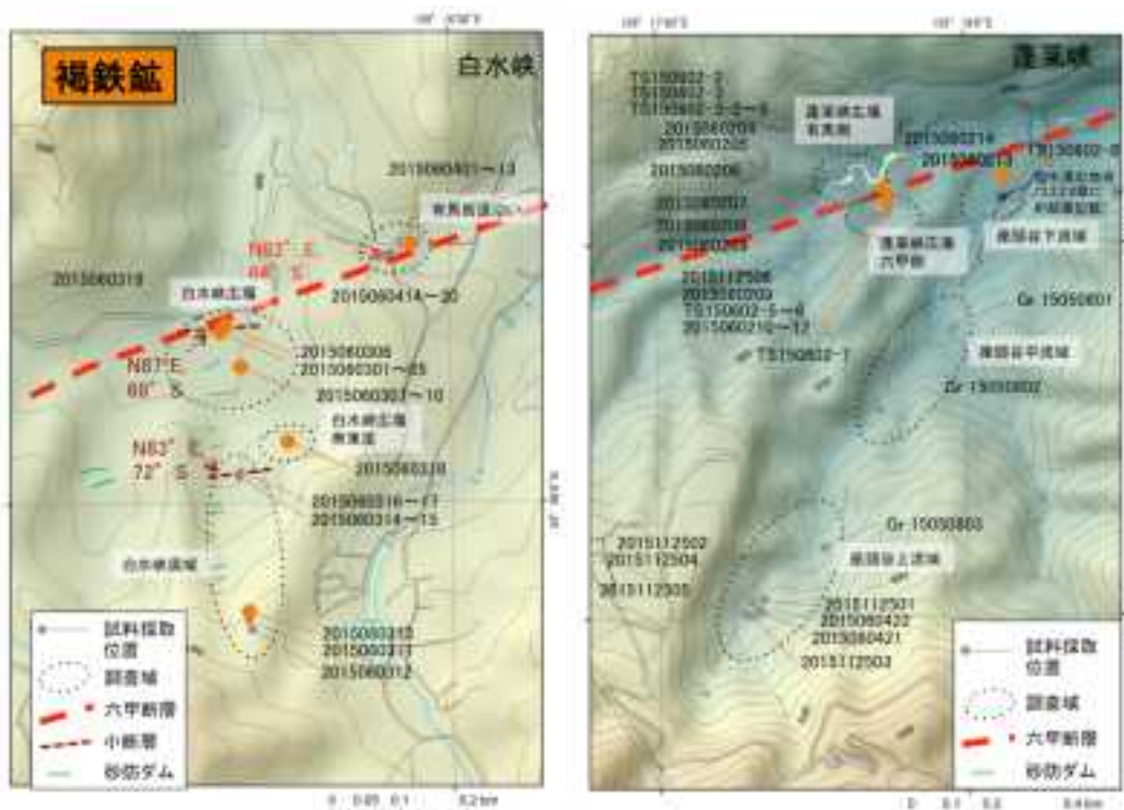
図 3.2.2.1-3 白水峡および蓬萊峡の変質鉱物の分布（褐鉄鉱） X線回折実験結果により産出位置をプロットした。
