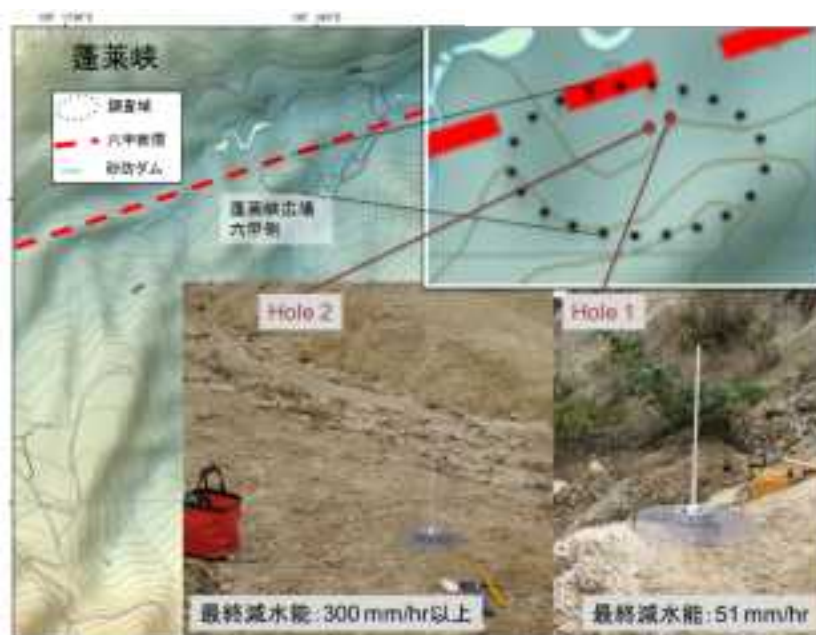
図 3.3.1.1-1 蓬萊峡広場_六甲側における調査位置図と長谷川式簡易透水試験結果
