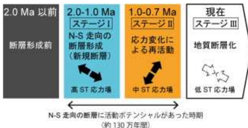
図 2.1.2-6 外房地域における最近 100 万年間の応力の時間変化と南北走向の地質図規模の断層の活動変化を示す概念図。
