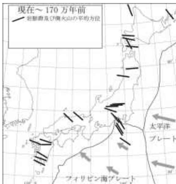
図 2.2.3-6 平行岩脈群の方位から推定される第四紀の広域応力場(山元, 1991 にプレート運動を加筆)。
