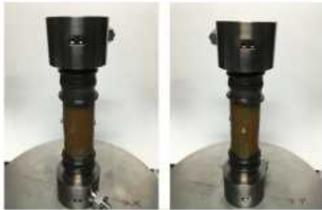
図 4.2.2.6-5 稚内層珪質頁岩（HDB9 孔；深度 358m）サンプルの室内三軸透水試験後の破断面の状況
