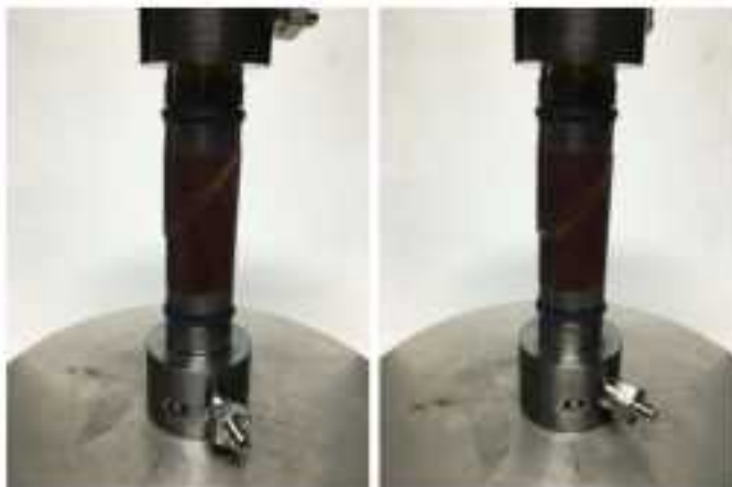
図 4.2.2.6-7 稚内層珪質頁岩（HDB9 孔深度 466m）サンプルの室内三軸透水試験後の破断面の状況
